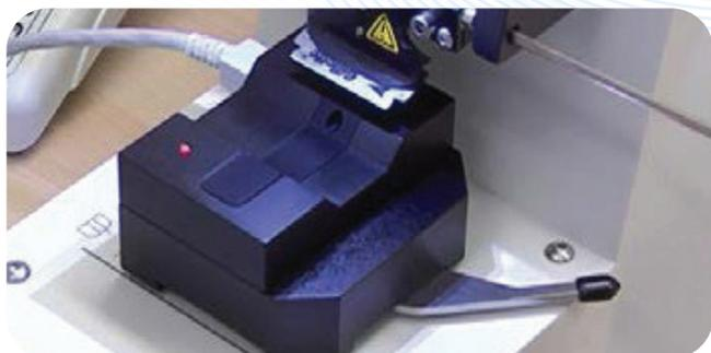
ブレードの垂直方向のブレは、Vibrocheck測定装置で測定できます。ブレードの調節によって垂直方向のブレを1 μm未満に最小化することができるので、生存細胞の数は大幅に増加します。
