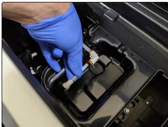
16. 按下橙色套筒以拆下拾取管和过滤器。
