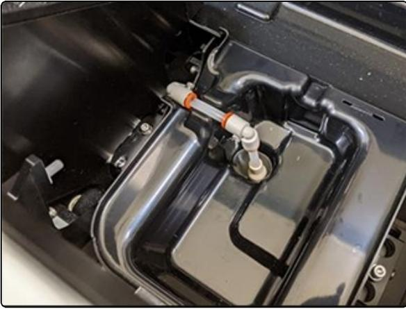
20. 将带过滤器的拾取管旋转到原始位置。
