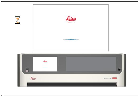
4. 打开处理模块后, 它会在显示登入屏幕之前进行初始化。这个过程需要 8-15 分钟。如果处理模块无法初始化, 请参阅 [5.1 无法初始化](#)。
