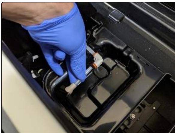
19. 将带过滤器的拾取管重新安装到橙色套筒中, 并确保将其完全推入。
