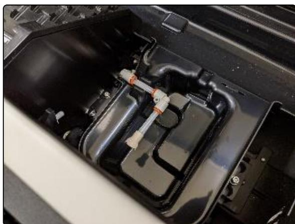
15. 在弯管处旋转带过滤器的拾取管。
