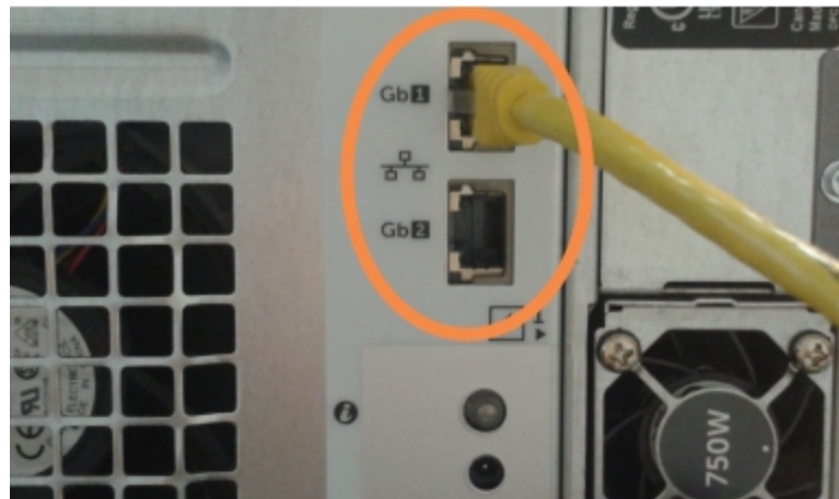
Hình 16-5: Các cổng Ethernet được sử dụng cho kết nối LIS
