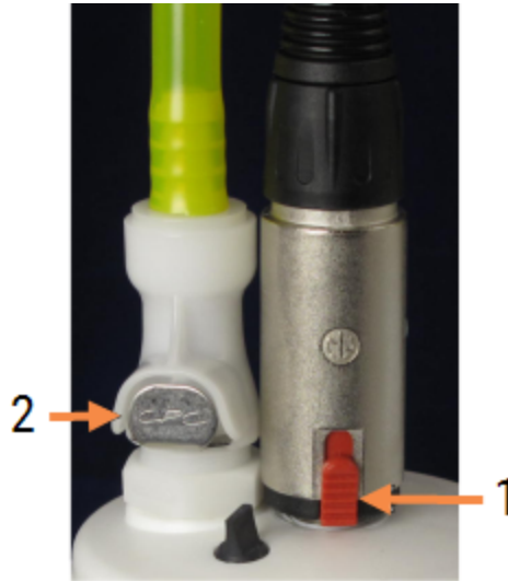
Hình 12-4: Đầu nối thùng chứa chất thải tiêu chuẩn bên ngoài
