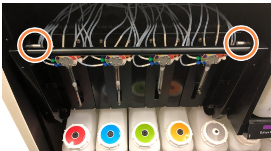
Hình 12-9: Vị trí của chốt nhả với thiết bị mở để truy cập
