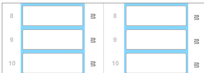
Hình 2-9: Biểu tượng bộ gia nhiệt màu xám ở mỗi vị trí biểu thị tắt hoàn toàn hệ thống gia nhiệt
