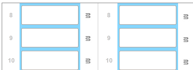
Hình 5-4: Biểu tượng bộ gia nhiệt màu xám ở mỗi vị trí biểu thị tắt hoàn toàn hệ thống gia nhiệt
