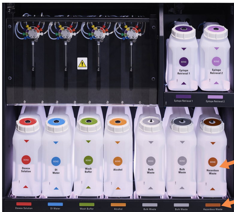
Hình 2-15: thùng chứa thuốc thử số lượng lớn ở vị trí BOND-III
