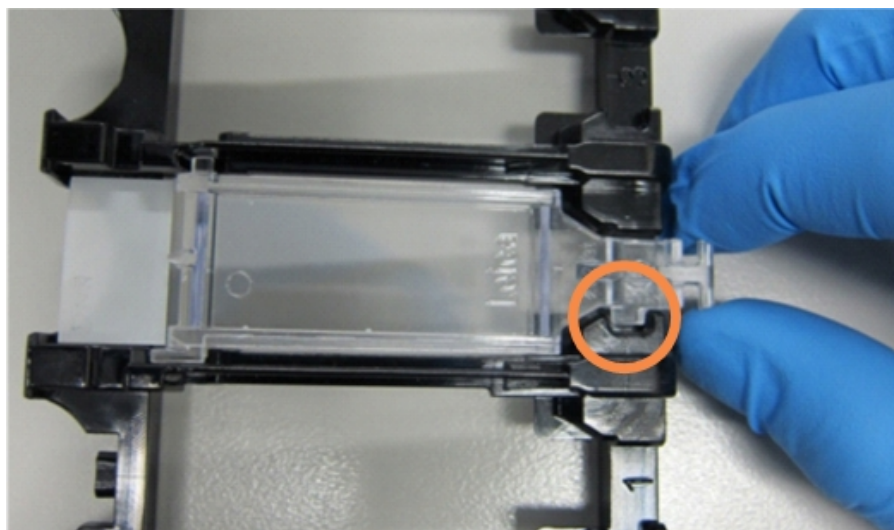
pav. 4–6: „Covertile“ uždėjimas ant objektinio stiklelio
