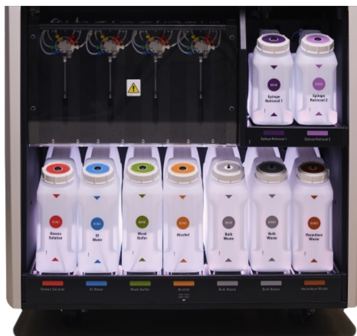
pav. 2-16: Bazinių indų apšvietimo sistema
