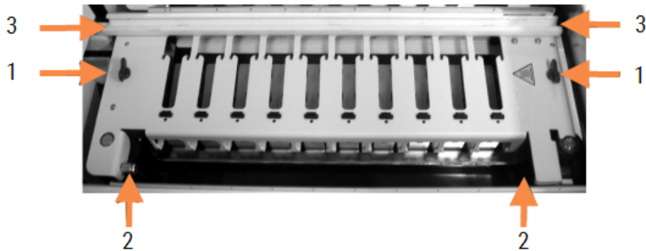
pav. 12–6: BOND-III viršutinė plokštė
