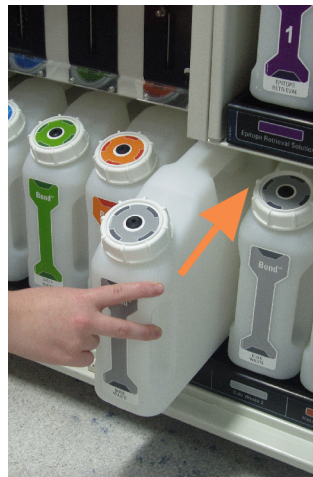
pav. 12–1: Atliekų laikymo indo gražinimas į vietą
