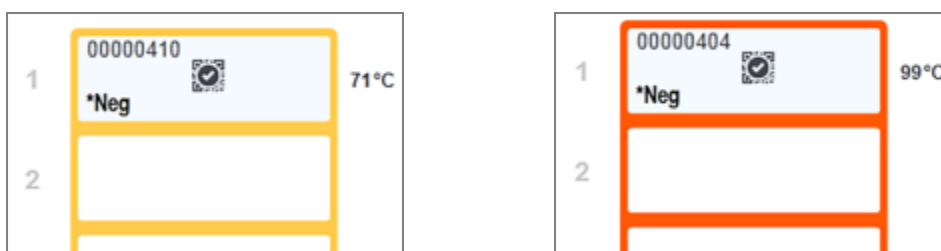
Attēls 5-6: Temperatūras indikācija slaidu paplāšu apmalēs: silta (kreisās puses attēls) un karsta (labās puses attēls).
