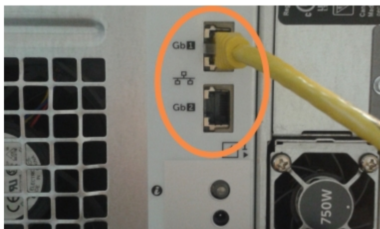
Attēls 16-5: LIS savienojuma izveidei izmantotie Ethernet pieslēgvietas
