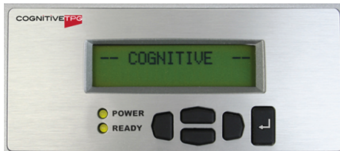
Attēls 17-1: Cognitive printera LCD displejs un tastatūra
