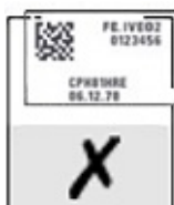
Slika 6–6: Postavite naljepnicu unutar rubova stakalca
