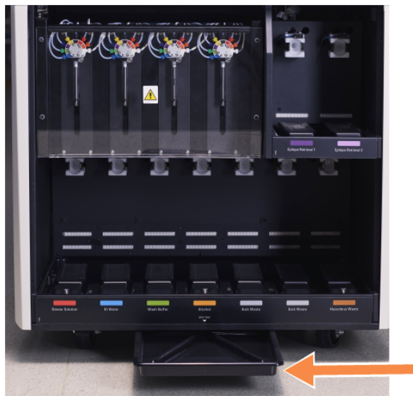
Slika 12-14: BOND-III posudica za kapanje modula obrade
