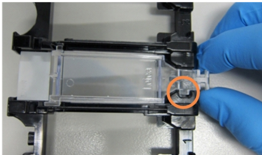
Slika 4-6: Postavljanje navlake na stakalce
