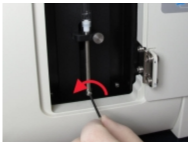
Slika 12–17: Imbus ključem odvrnite vijak za blokiranje klipa
