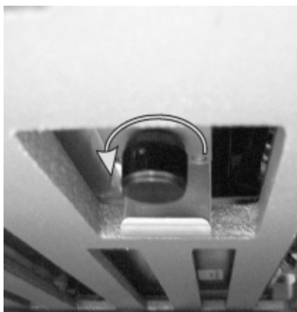
Сурет 12-10: Бұғаттан қолмен босату тұтқасы
