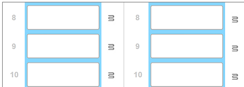
Сурет 2-9: Қыздырғыштардың сұр белгішелері барлық оқиғаларда қыздырудың толық өшірілуін көрсетеді
