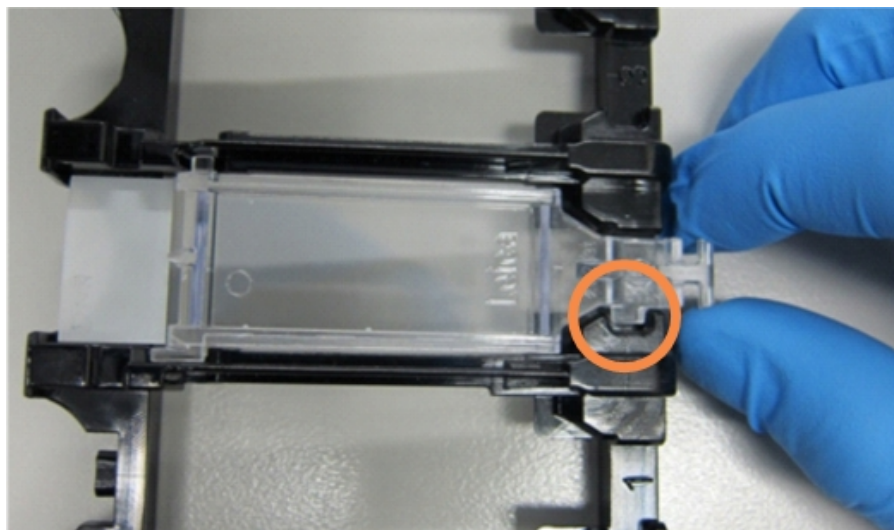
Сурет 4-6: Covertile қақпақшасын препаратқа орнату
