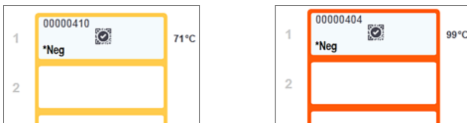
Сурет 5-6: Препараттарға арналған науашалардың шектеріндегі температураны индикациялау: жылы (сол жақта) және ыстық (оң жақта)
