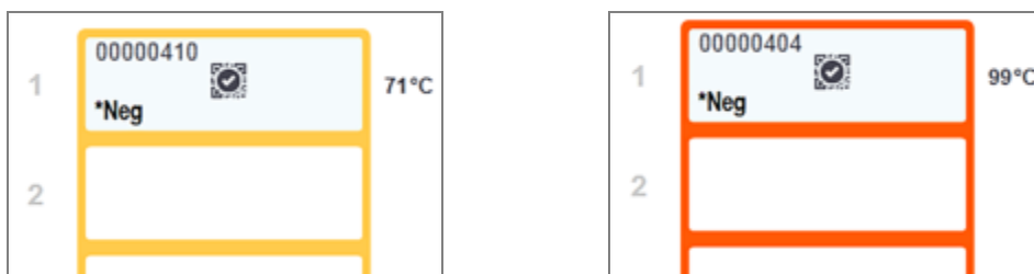
Малюнок 5-6: Індикація температури на межах лотків для препаратів: теплий (зліва) та гарячий (праворуч)
