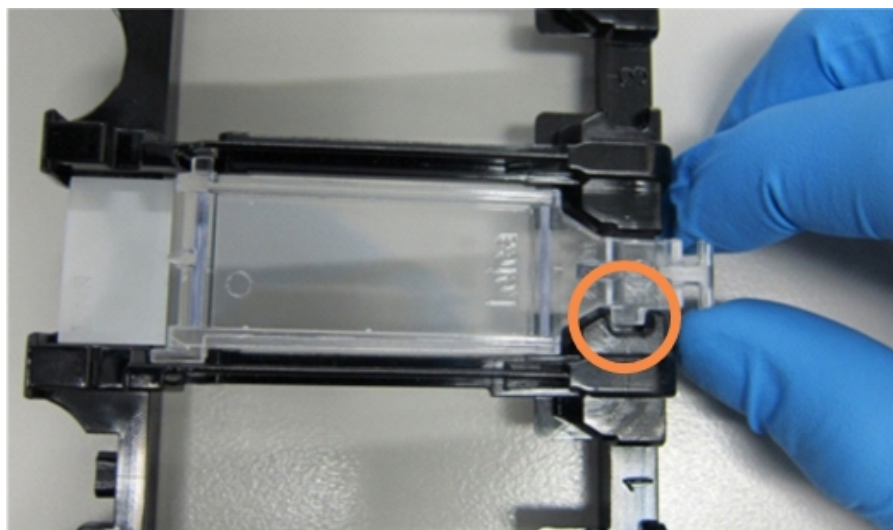
Joonis 4-6: Covertile'i katteplaadi paigutamine objektiklaasile
