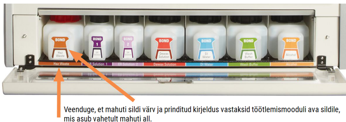
Joonis 2-17: BOND-MAX põhianereaktiivid õiges asendis
