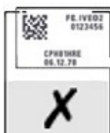
Joonis 6-6: Asetage silt objektiklaasi servadest sissepoole
