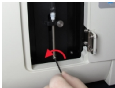
Joonis 12-17: Kolvi lukustuskrugi lahtikeeramine kuuskantvõtmega
