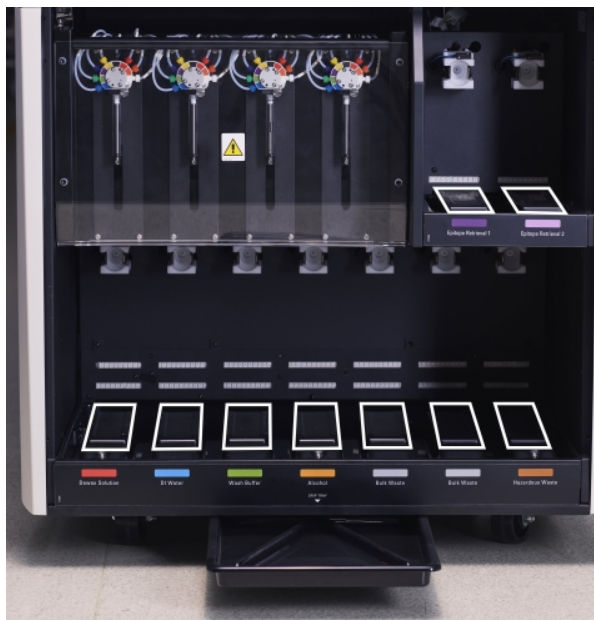
Joonis 12-13: BOND-III kanistrite lekkealused, millel on näha kaaluanduri katteid
