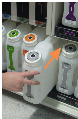
Joonis 12-1: Jäätmekanistri asetamine tagasi oma kohale
