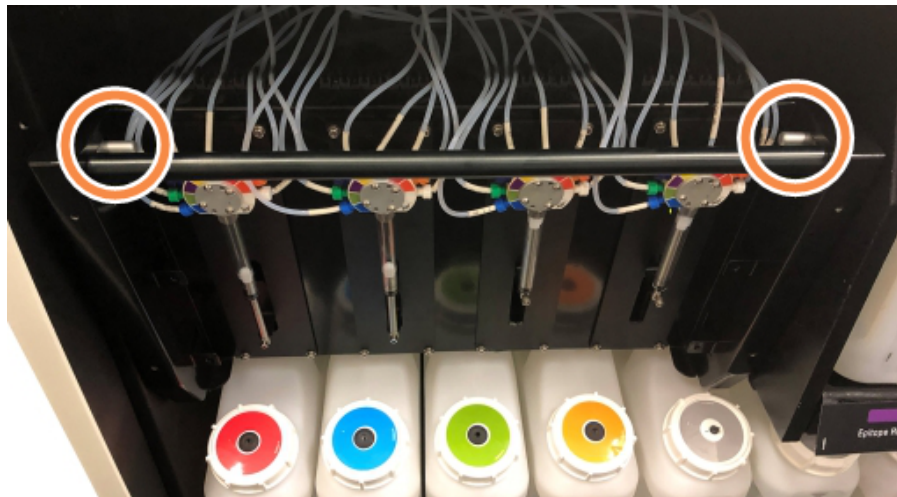
Joonis 12-9: Vabastustihvtide asukoht avatud seadmel
