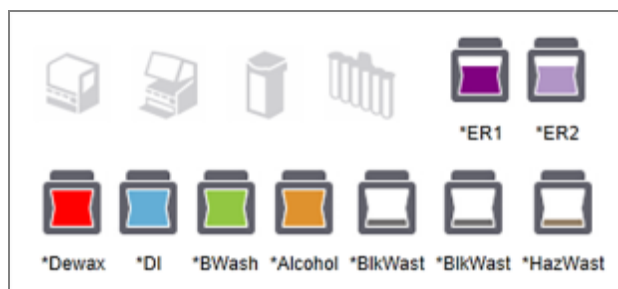
Joonis 5-12: Kanistrid (BOND-III konfiguratsioon)
