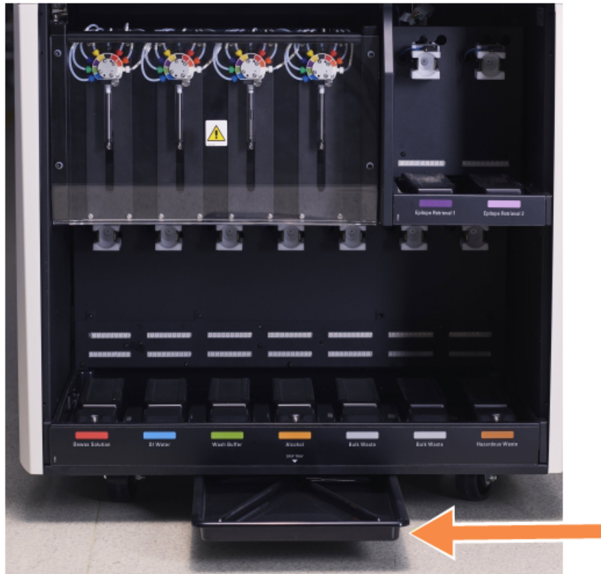
Obrázok 12-14: Odkvapkávací podnos modulu spracovania BOND-III
