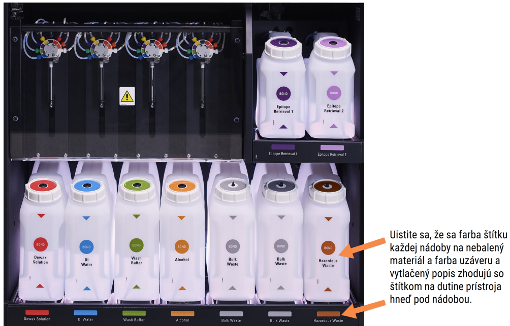
Obrázok 2-15: Nádoby na nebalené reagenty BOND-III na svojom mieste
