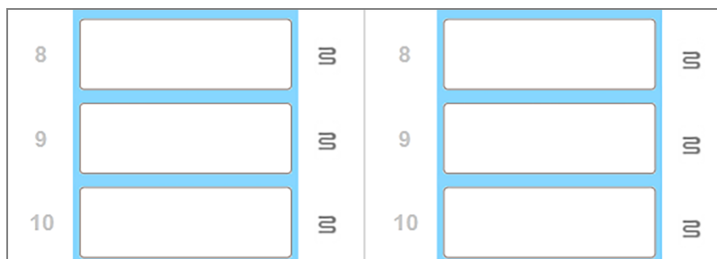
Obrázok 5-4: Sivé symboly ohrievača v každej polohe označujú úplné vypnutie vyhrievania
