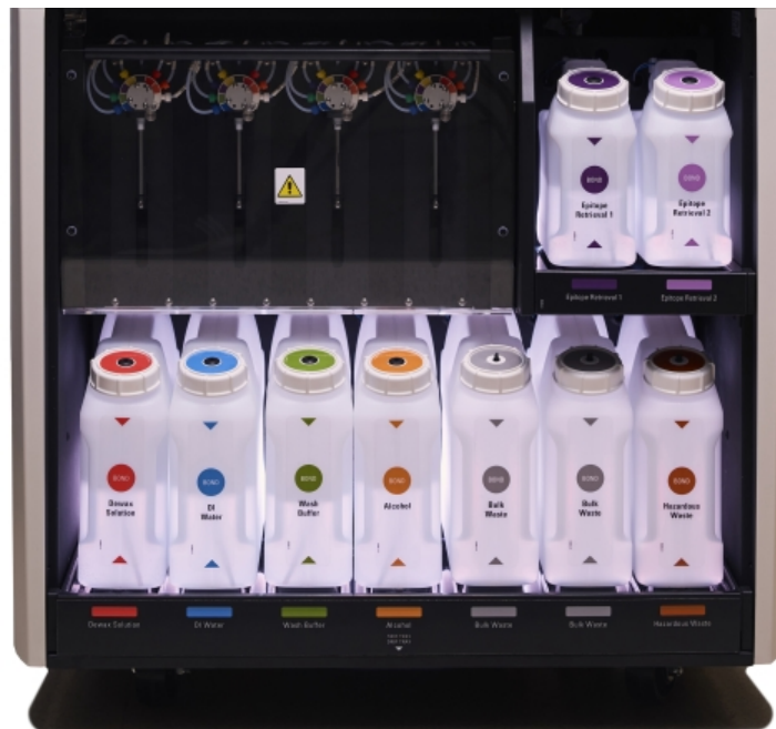
Obrázok 2-16: System osvetlenia nádob na nebalený materiál
