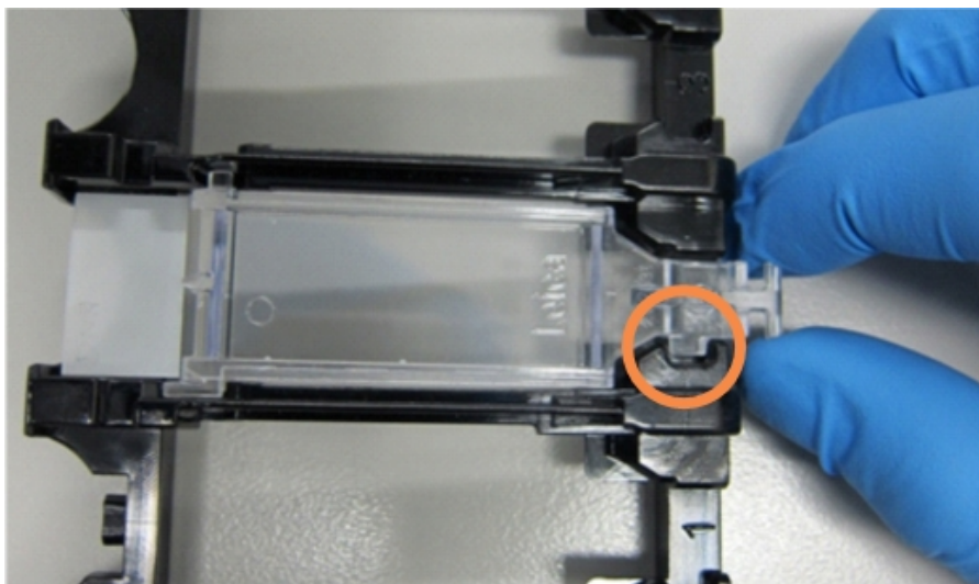
Obrázok 4-6: Umiestnenie krycieho sklíčka Covertile na podložné sklíčko
