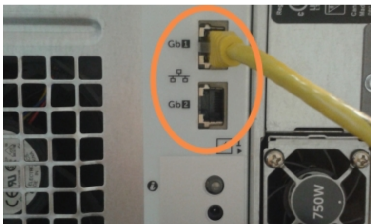
Obrázok 16-5: Ethernetové porty používané pre pripojenie LIS
