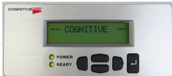
Фигура 17-1: LCD екран и клавиатура на принтер Cognitive
