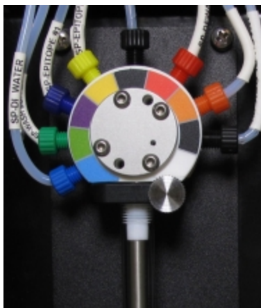
Фигура 2-24: 9-портова спринцовка BOND-MAX
