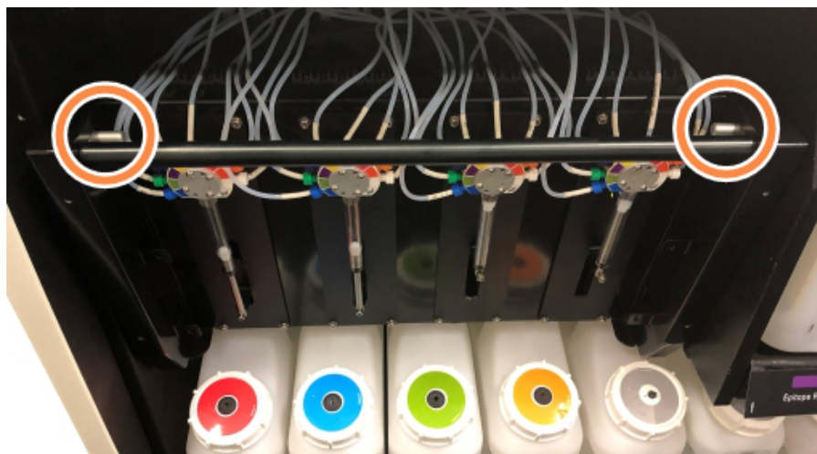
Фигура 12-9: Местоположение на освобождаващите щифтове с отворено устройство за достъп
