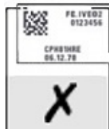
Фигура 6-6: Поставяне на етикета в рамките на ръбовете на предметното стъкло
