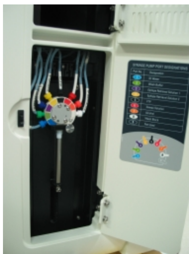
Фигура 2-6: Спринцовка зад врата на панти
