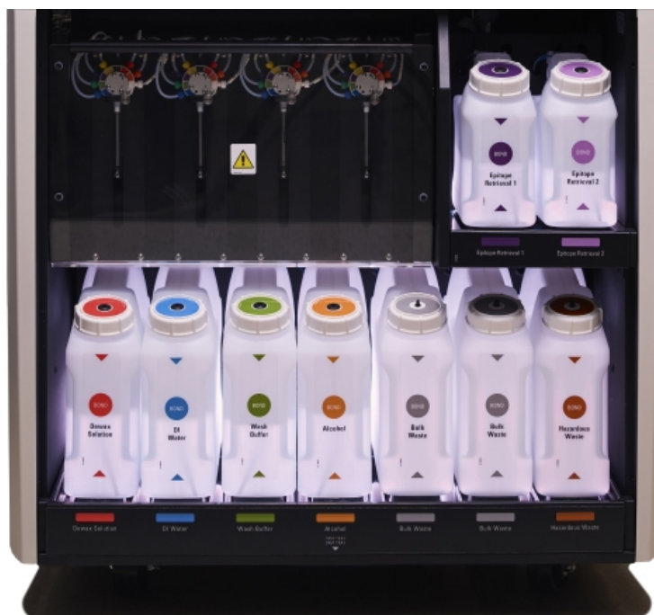
Фигура 2-16: Светлинна система на наливните резервоари
