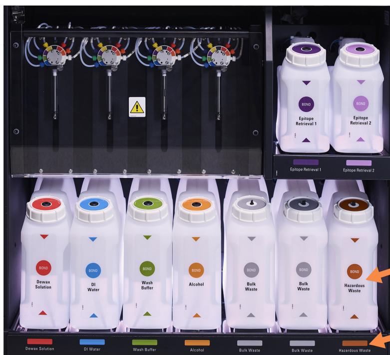
Фигура 2-15: Резервоари за наливни реагенти BOND-III в позиция
