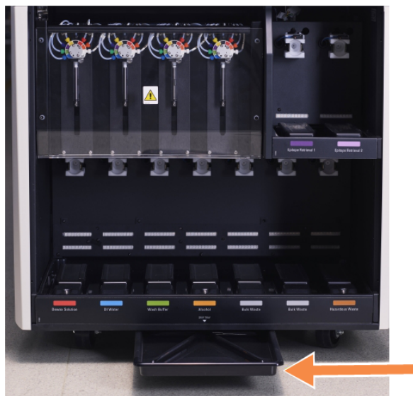
Фигура 12-14: BOND-III Табла за отцеждане на модула за обработка
