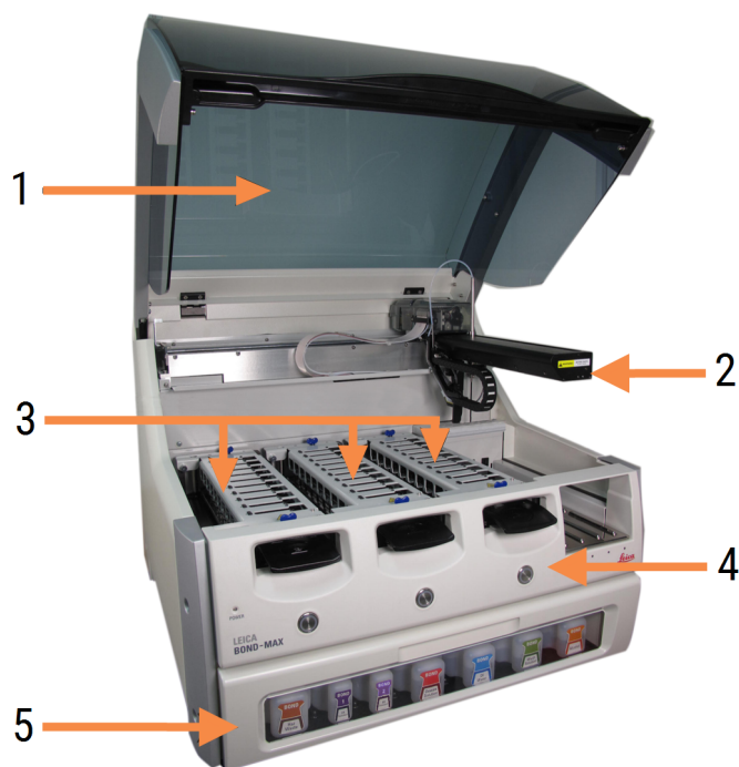
Figură 2-4: Vedere frontală a modului de procesare BOND-MAX
