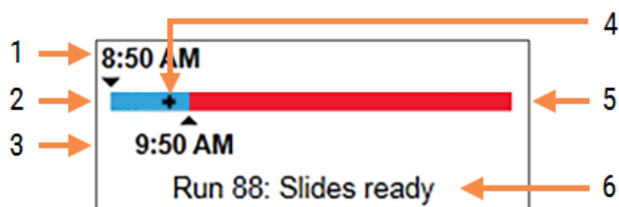
Figură 5-22: Progres executare (pornire)
