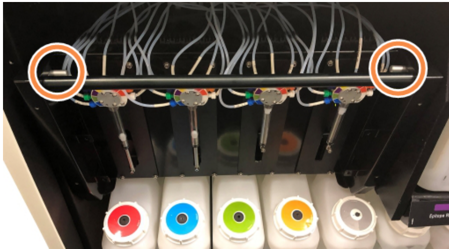
Figură 12-9: Amplasarea pinilor de eliberare cu unitatea deschisă pentru acces
