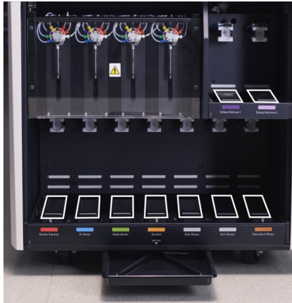
Figură 12-13: Tăvi de picurare pentru recipiente vrac BOND-III, care prezintă acoperitoarele senzorilor de greutate
