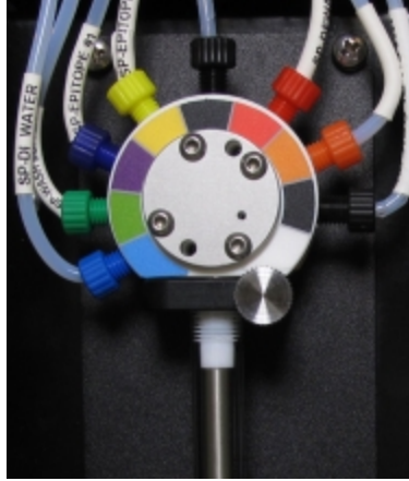
Şekil 2-24: BOND-MAX 9-portlu şırınga
