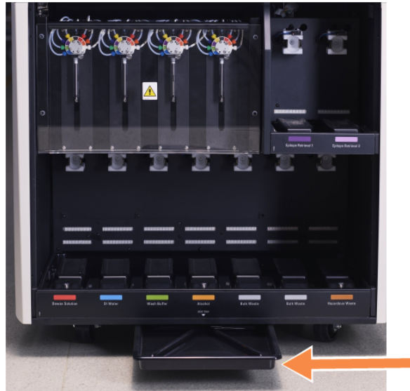
Şekil 12-14: BOND-III cihaz damlama tepsisi
