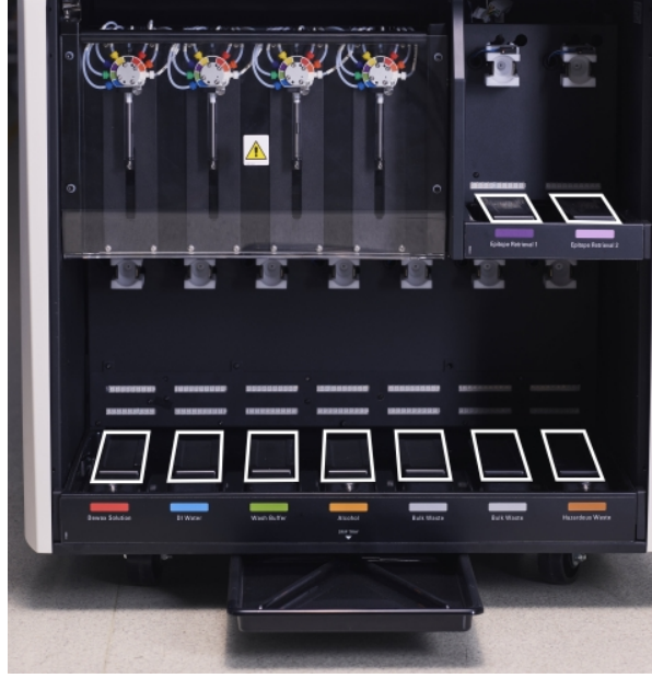
Şekil 12-13: BOND-III bidon damlama tepsileri ağırlık sensörü kapaklarını gösteriyor
