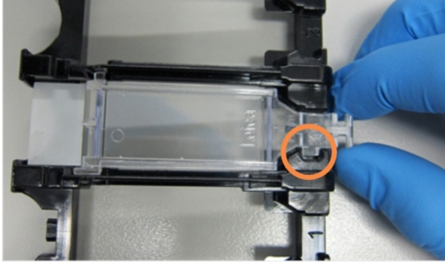
Şekil 4-6: Bir lam üzerinde Covertile'ın konumlandırılması
