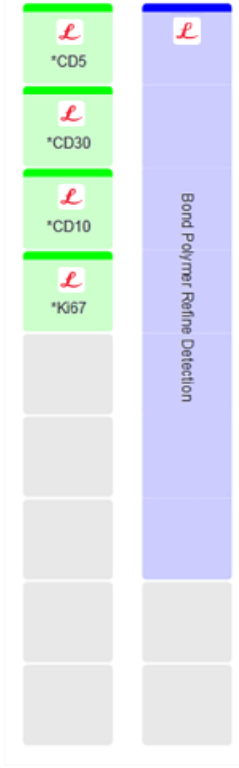
Şekil 4-9: Sistem durumu ekranında gösterildiği şekilde reaktif tepsi durumu
