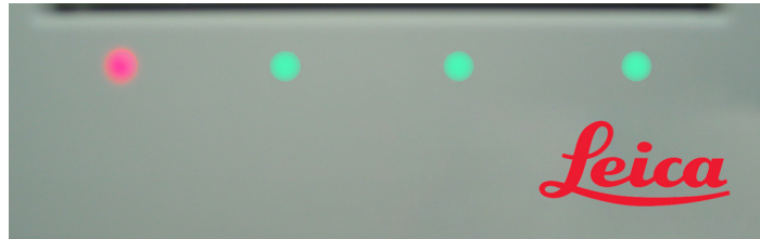
Şekil 2-14: Reaktif tepsisi LED renkleri (kırmızı, yeşil) BOND-MAX cihazı üzerinde
