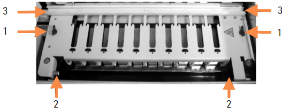
Şekil 12-6: BOND-III Üst Plakayı
