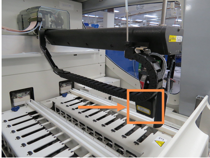
Şekil 2-7: Kimlik görüntüleyici ok ile gösterilen ana robot fotoğrafı
