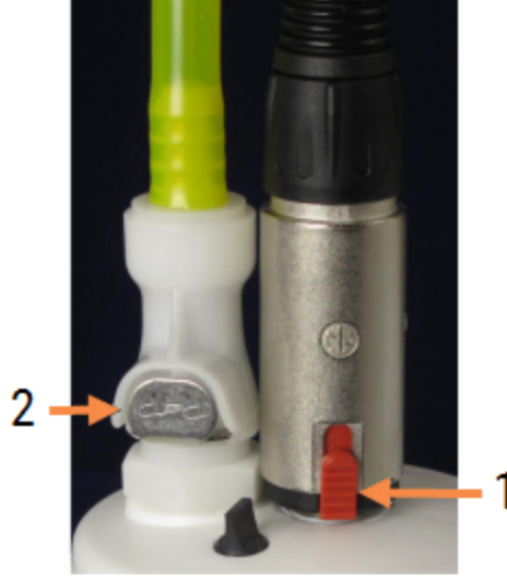
Şekil 12-4: Harici atık konteynırı bağlantıları
