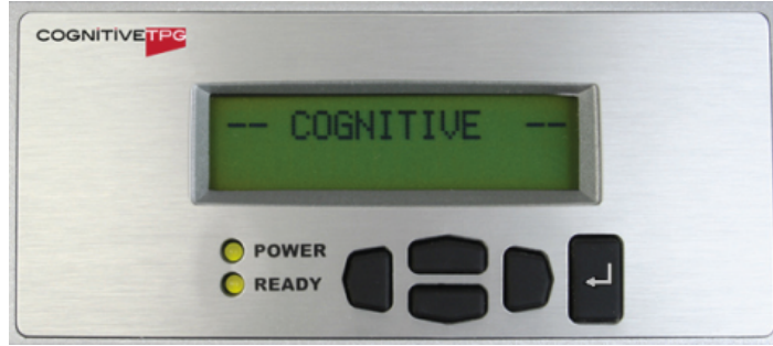
Şekil 17-1: Kognitif Yazıcı LCD ekran ve klavye
