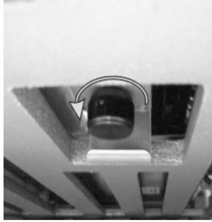
Şekil 12-10: Manuel serbest bırakma düğmesi
