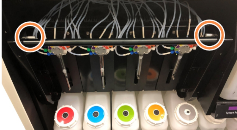
Şekil 12-9: Ünite erişim için açık olduğunda serbest bırakma pinlerinin konumu
