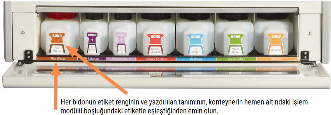
Şekil 2-17: BOND-MAX kimyasal reaktifleri konumlarında
