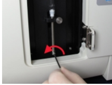
Şekil 12-17: Piston kilit vidasını altıgen anahtarla açma
