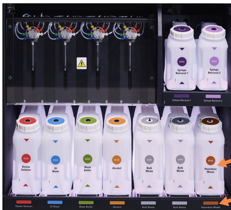
Figura 2-15: Tanques de solução BOND-III na posição
