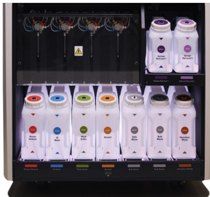
Figura 2-16: Sistema de iluminação do tanque de solução
