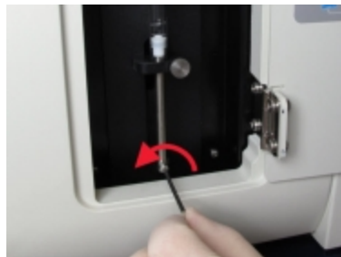
Figur 12-17: Borttagning av dopparens låsskruv med en sexkantnyckel
