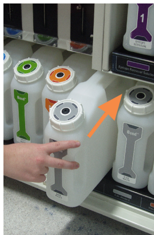
Figur 12-1: Sätt tillbaka avfallsbehållaren på dess plats
