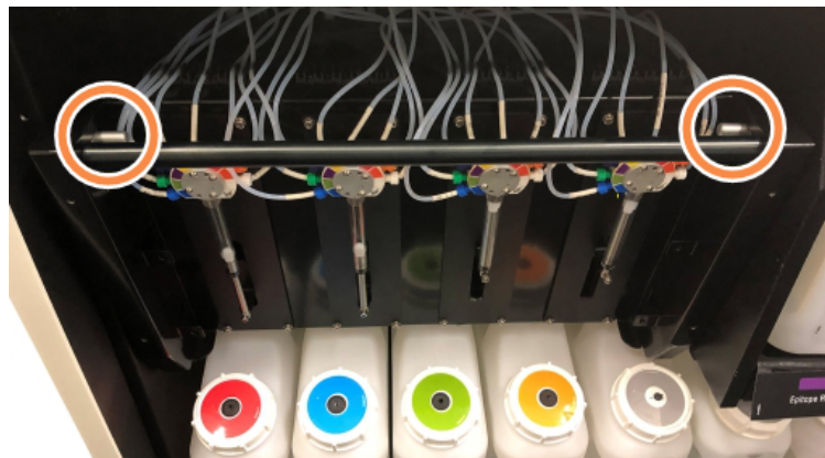
Figur 12-9: Placering av frigöringspinnarna med enheten öppen för åtkomst
