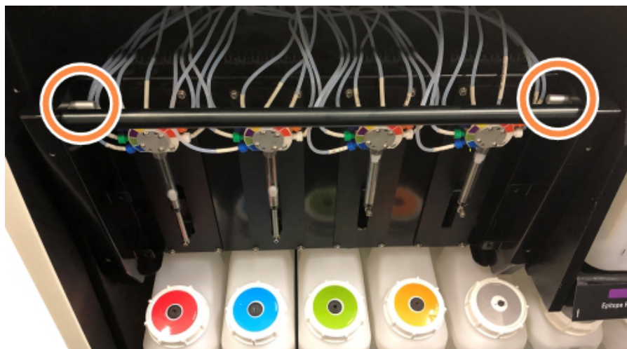
Figura 12-9: Ubicación de los pasadores de liberación con la unidad abierta para el acceso
