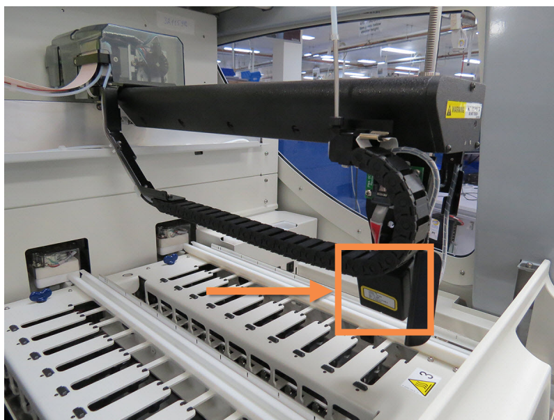
Figura 2-7: fotografía del robot principal con la flecha indicando la posición del lector de ID
