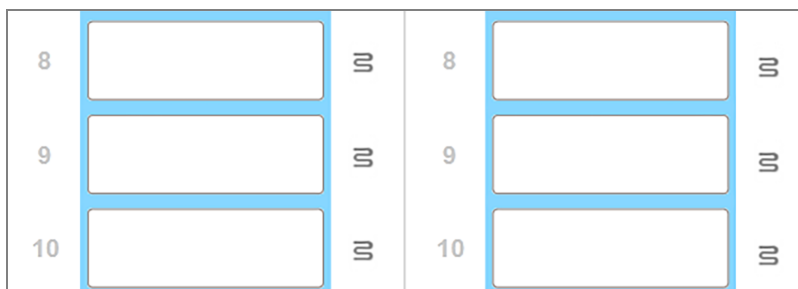
Figura 5-4: Los símbolos de calentador en gris en cada posición indican un apagado completo de la calefacción
