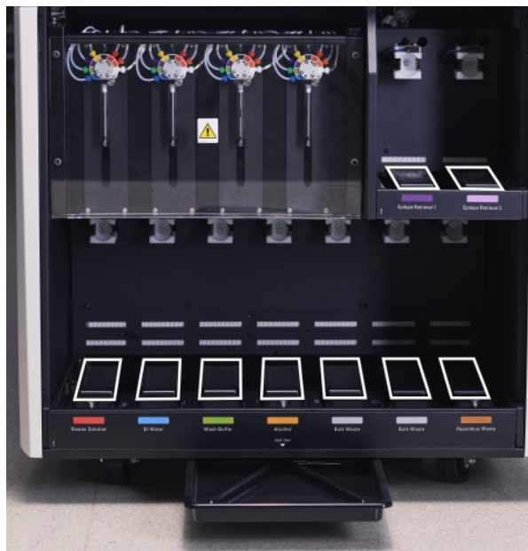
Figura 12-13: bandejas de goteo de recipientes a granel de BOND-III mostrando las cubiertas de los sensores de peso
