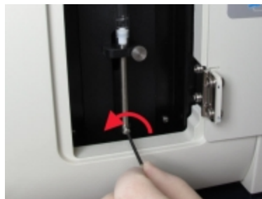
Figura 12-17: desenroscar el tornillo de bloqueo del émbolo con una llave hexagonal
