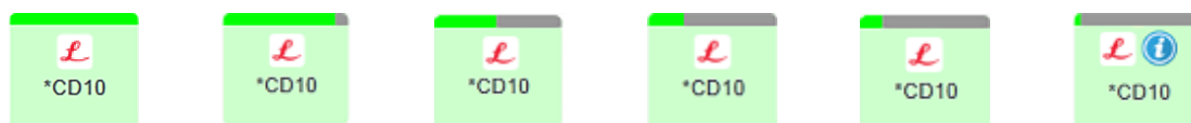
Figura 5-7: Ejemplos de niveles de reactivos listos para usar mostrados en la pantalla Estado del sistema
