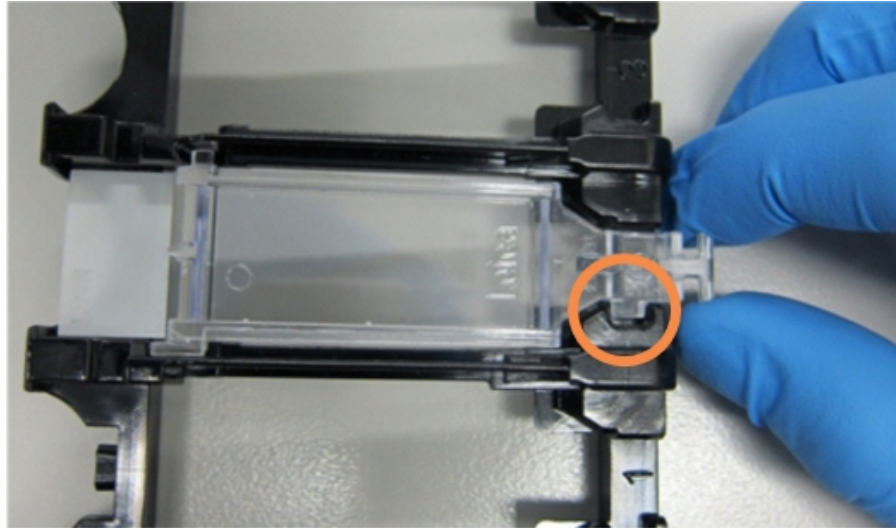
Slika 4-6: Postavljanje Covertile poklopca na slajd
