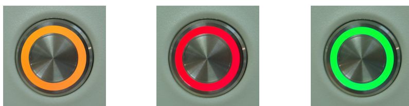
Рис. 2-13: Цвета светодиодов лотка для препаратов (оранжевый, красный, зеленый) на модуле обработки BOND-MAX
