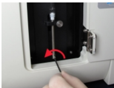
Рис. 12-17: Отвинчивание стопорного винта поршня шестигранным ключом
