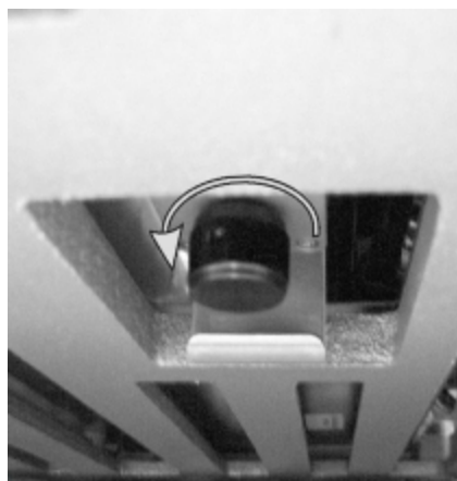
Рис. 12-10: Ручка ручной разблокировки
