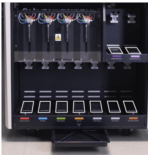
Рис. 12-13: Поддоны для больших контейнеров BOND-III, демонстрирующие крышки датчиков веса
