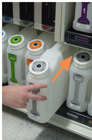
Figura 12-1: Voltar a colocar o contentor de resíduos na sua posição
