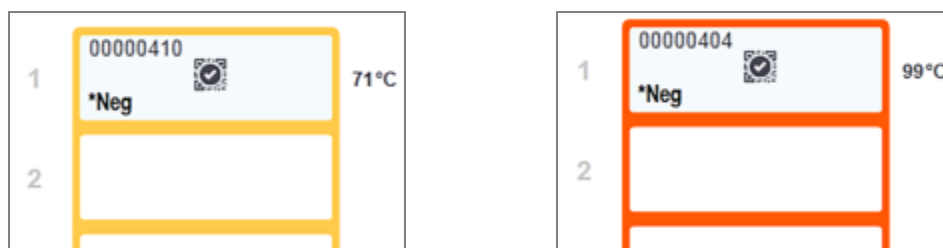
Figura 5-6: Indicação de temperatura nos bordos dos suportes de lâminas: morno (esquerda) e quente (direita)
