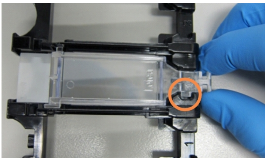
Figura 4-6: Posicionar um Covertile numa lâmina
