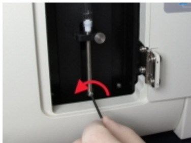
Figura 12-17: A desapertar o parafuso bloqueador do êmbolo com uma chave hexagonal.
