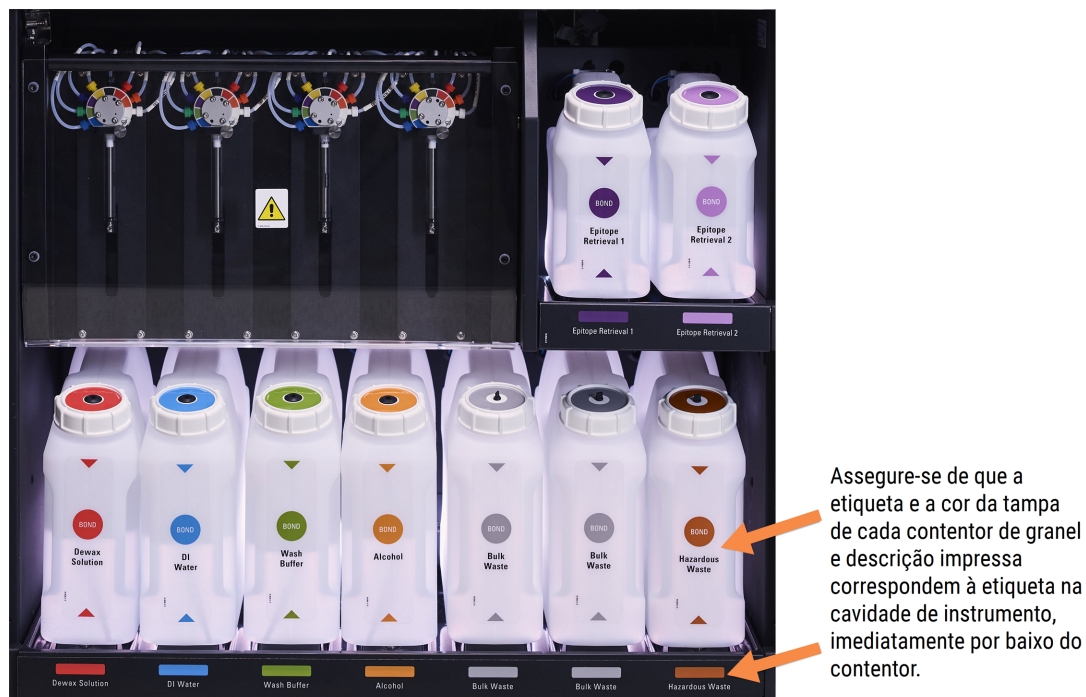
Figura 2-15: BOND-III contentores de reagentes a granel em posição
