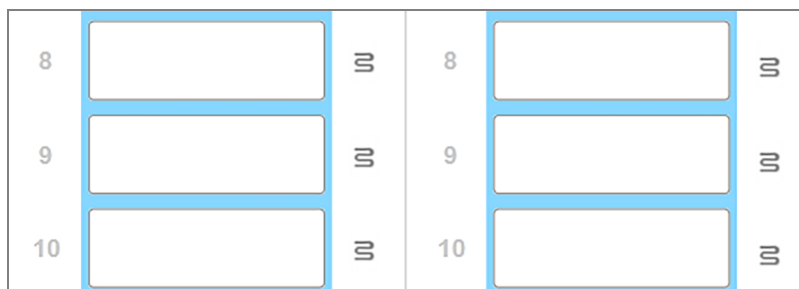
Figura 5-4: Símbolos de aquecedor cinzentos em cada posição indicam paragem completa do aquecimento
