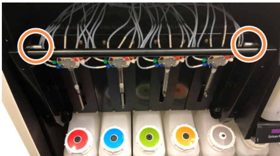
Figura 12-9: Localização dos pinos de libertação com a unidade aberta para acesso
