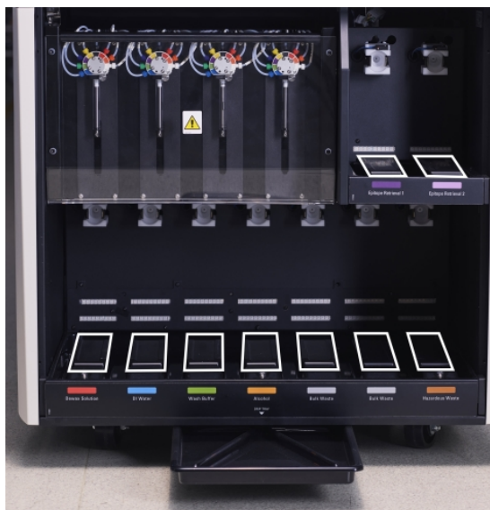
Figura 12-13: Suportes coletores do contentor de granel BOND-III mostrando as tampas do sensor de peso
