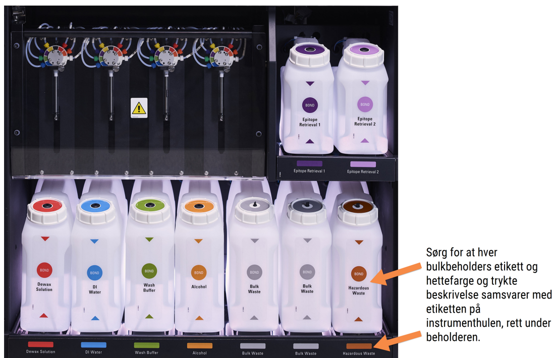
Figur 2-15: BOND III-bulkreagensbeholdere i posisjon
