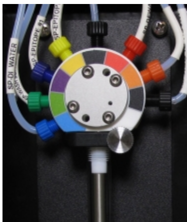
Figur 2-24: BOND-MAX Sprøyte med 9 porter
