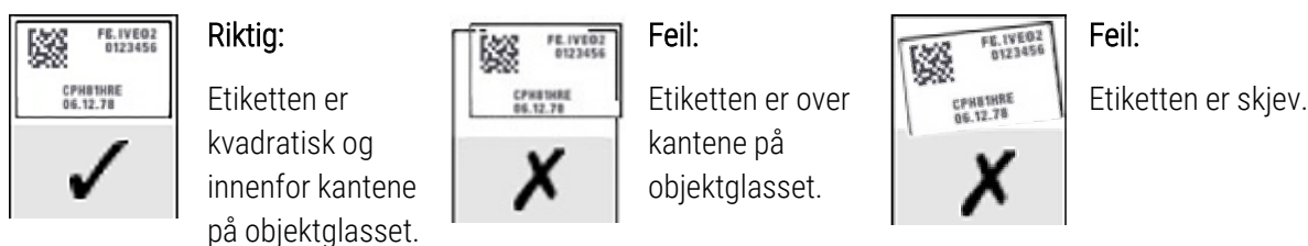
Figur 6-6: Plasser etiketten innenfor kantene på objektglasset
