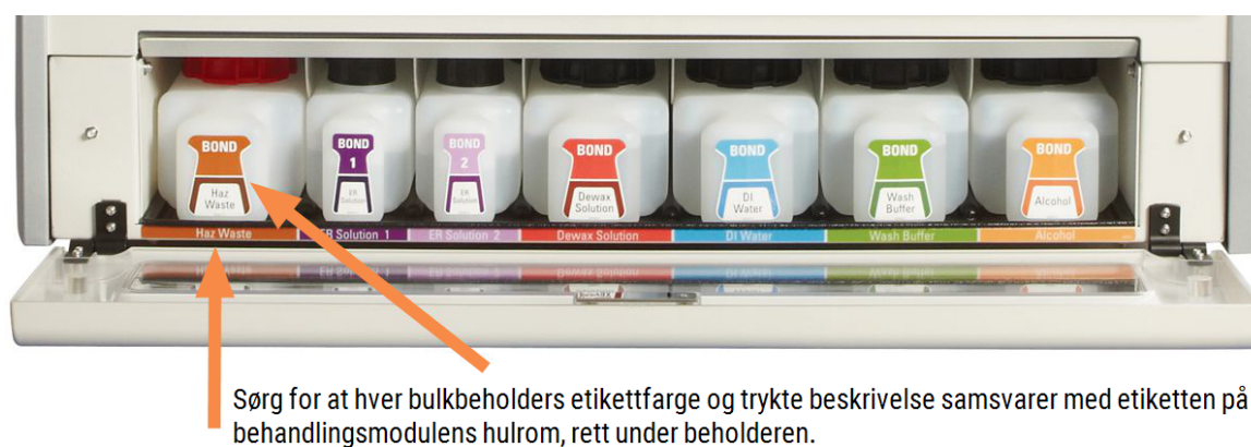
Figur 2-17: BOND-MAX-bulkreagenser i posisjon
