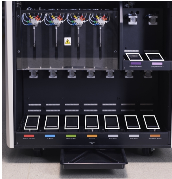
Figur 12-13: BOND III-dryppbrett for bulkbeholder som viservektsensordeksler
