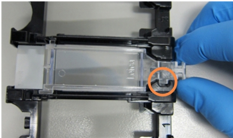
Figur 4-6: Plassering av en Covertile på et objektglass
