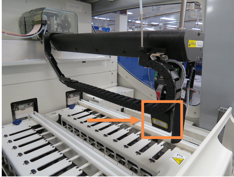
그림 2-7: ID 이미저(화살표로 표시)가 장착되어 있는 기본 로봇의 사진
