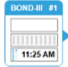
各タブには処理モジュール名が表示され、長方形アイコンにはモジュールのスライド染色ユニットの状態が表示されます (下記参照)。処理モジュールのシステム状態画面を表示するには、タブをクリックします。それが選択されると、処理モジュールタブの周囲に、青のアウトラインと右向きの矢印が表示されます (上記参照)。
