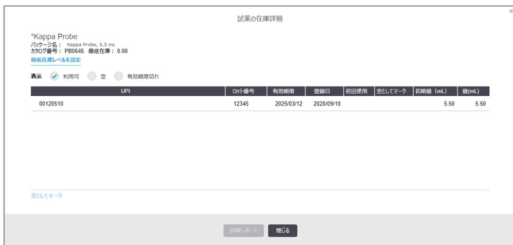
在庫詳細ダイアログボックスには、選択した試薬やシステムの個々のパッケージが表示されます。ダイアログフィールドおよびオプションは、試薬パッケージのタイプとサプライヤーによって異なります。初期設定では、利用可能で有効期限内の試薬パッケージのみが表示されます。また、有効期限内の空のパッケージや先月に有効期限切れとなった全てのパッケージを表示することができます。ダイアログで、必要に応じて**利用可**、**空**または**有効期限切れ**を選択します。
