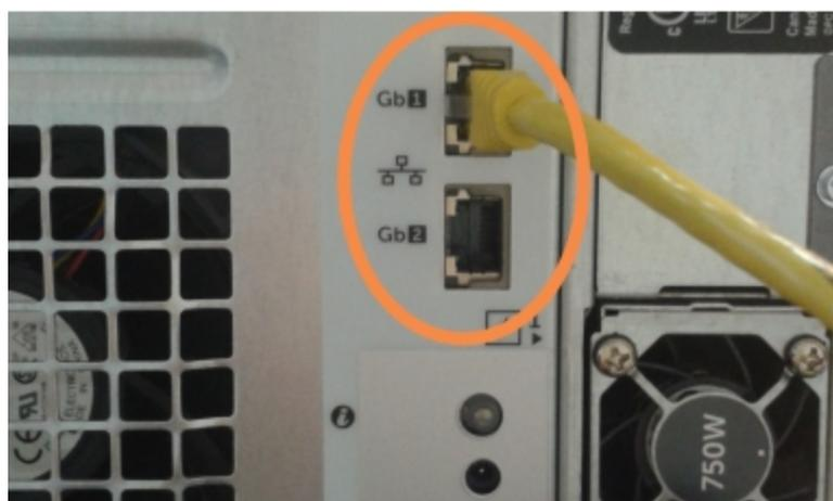
BOND-ADVANCE システムは、第二コントローラーにネットワークケーブルが接続されていて、全てのターミナルに確認ダイアログが表示されていることを検出します。
