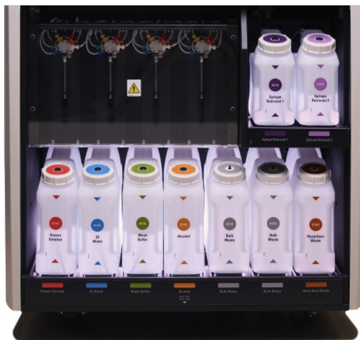
Figura 2-16: Sistema di illuminazione per contenitori in bulk
