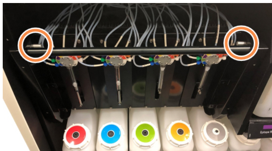
Figura 12-9: Posizione dei perni di rilascio con l'unità aperta per l'accesso
