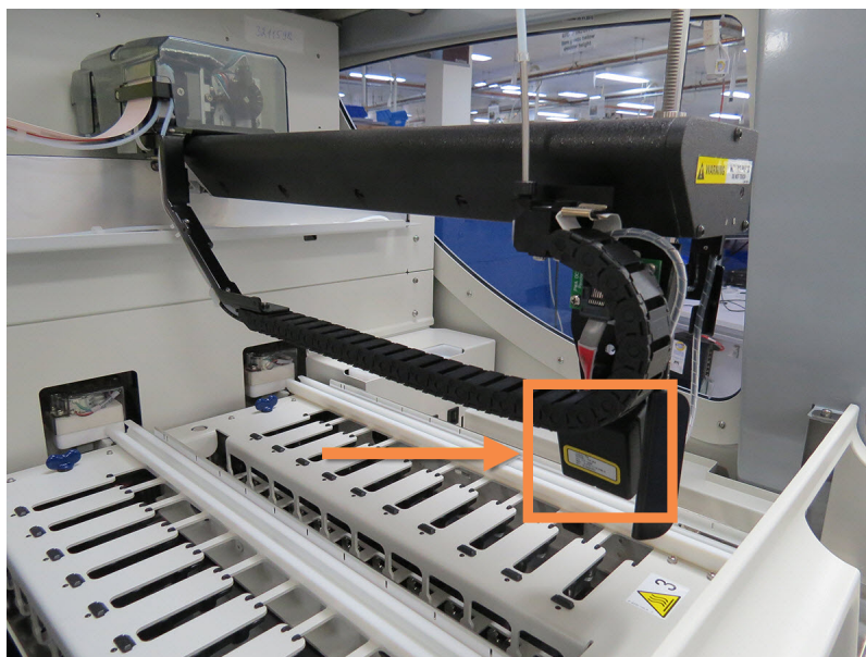
Figura 2-7: Immagine del braccio robotizzato principale con l'imager ID indicato dalla freccia
