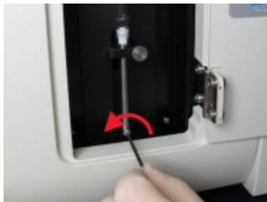
Figura 12-17: Svitare la vite di chiusura dello stantuffo con un cacciavite esagonale
