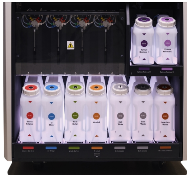
Ábra 2-16: Nagy folyadéktérfogatú tartály világítórendszer
