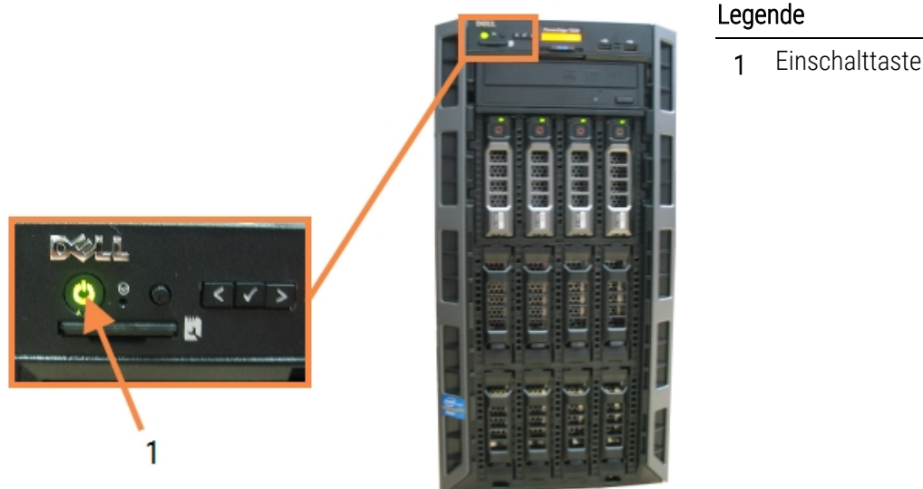
Abbildung 16-1: Position des Netzschalters an der Gerätefront des Controllers (mit abgenommener Abdeckung dargestellt)
