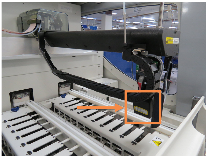
Abbildung 2-7: Abbildung des Hauptroboters mit dem durch einen Pfeil gekennzeichneten ID-Imager
