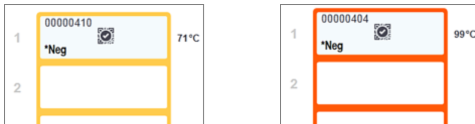
Figure 5-6: Indication de température sur le bord des plateaux de lames : tiède (gauche) et chaud (droite)
