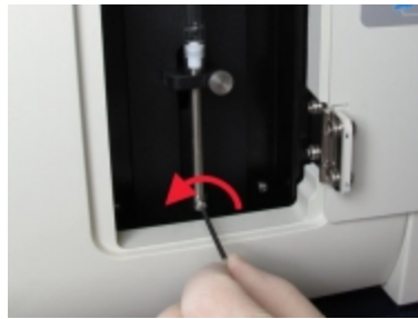
Figure 12-17: Dévissez la vis de blocage du plongeur avec une clé hexagonale
