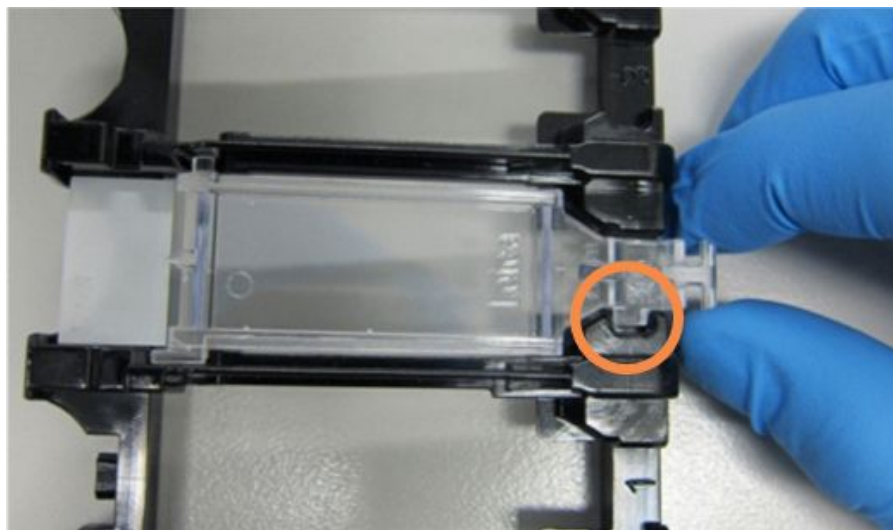
Figure 4-6: Mise en place d'un Covertile sur une lame
