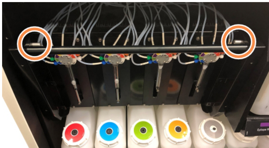
Kuva 12-9: Vapautustappien sijainti laitteen ollessa auki
