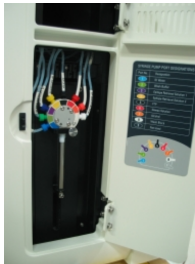
Kuva 2-6: Ruisku saranallisen luukun takana
