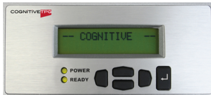
Kuva 17-1: Cognitive-tulostimen LCD-näyttö ja näppäimistö
