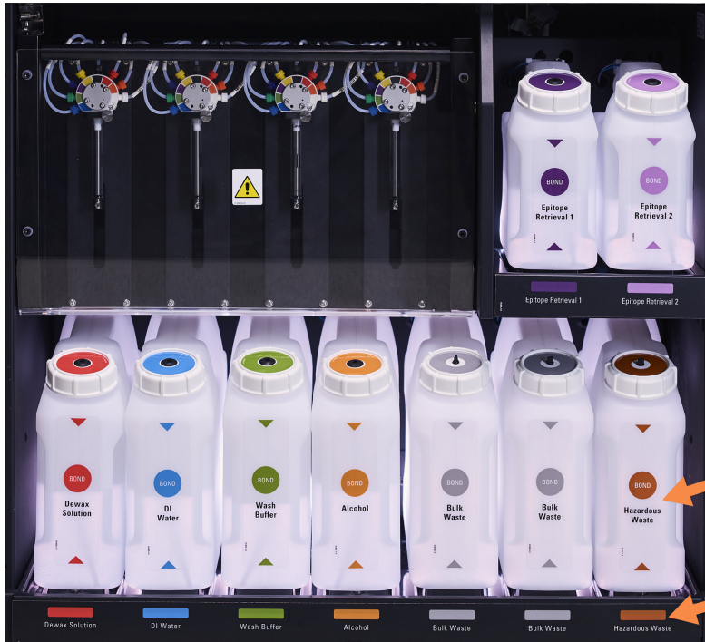
Kuva 2-15: BOND-III-bulkkireagenssisäiliöt omilla paikoillaan
