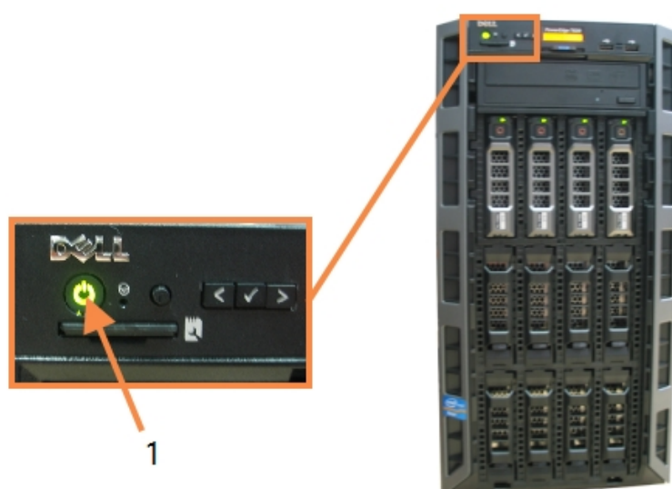
Afbeelding 16-1: Locatie stroomschakelaar op voorplaat van controller (afgebeeld met weggehaalde plaat)
