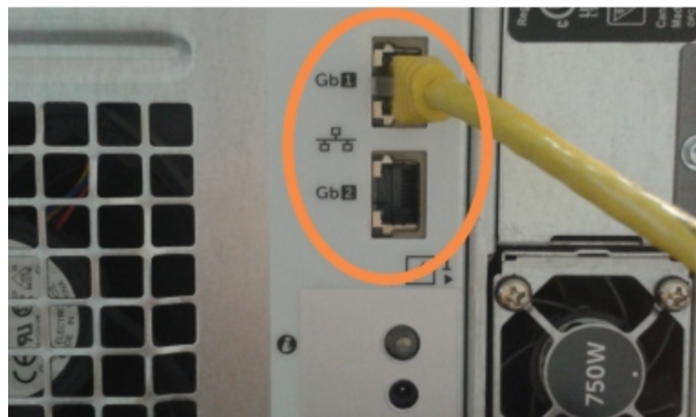
Afbeelding 16-5: Ethernetpoorten gebruikt voor BOND RemoteCare
