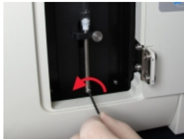
Afbeelding 12-17: Schroef het zuigerslot los met een inbussleutel
