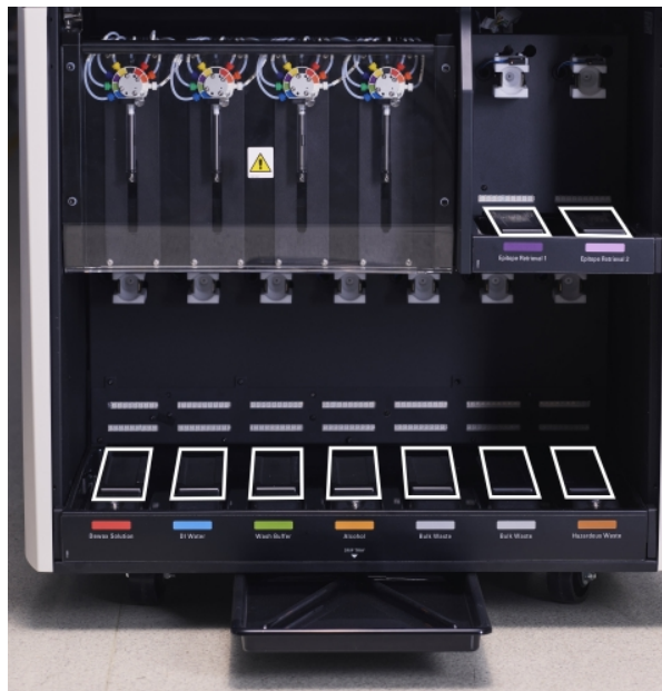
Afbeelding 12-13: BOND-III-bulkcontainer lekbakken met de platen over de gewichtssensoren
