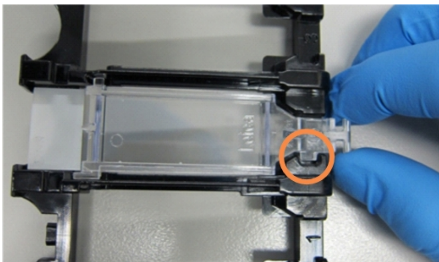
Afbeelding 4-6: Een dekplaatje op een objectglaasje plaatsen
