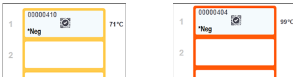
Afbeelding 5-6: Randen van de temperatuurindicatie van de glaasjesrekken: warm (links) en heet (rechts)
