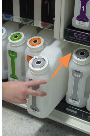
Afbeelding 12-1: De afvalcontainer op zijn plek terugzetten
