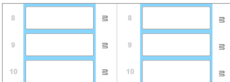
Afbeelding 5-4: Grijs symbolen van verwarmingselementen op elke positie geven een complete uitschakeling van de verhitting aan
