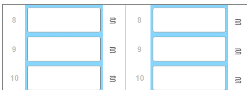
Figur 2-9: Grå symboler ved varmelegemet på hver plads betyder, at der er initieret en fuld nedlukning af varmelegemerne
