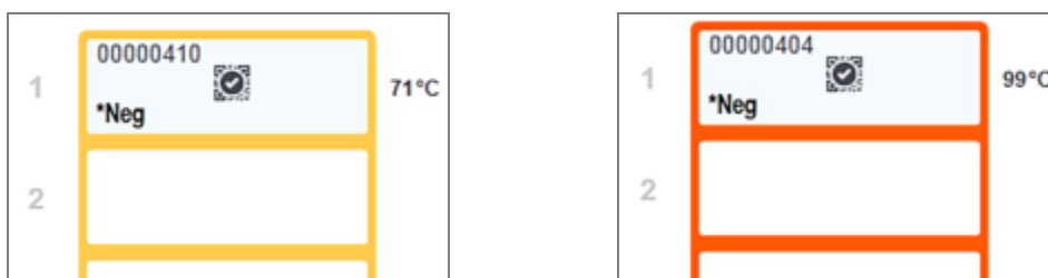
Figur 5-6: Temperaturindikationskanterne på objektglasbakkerne: varm (venstre) og meget varm (til højre)
