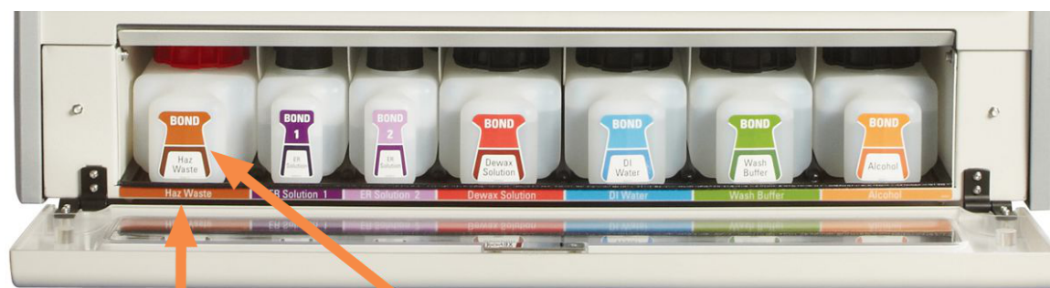
圖 2-17: 位於正確位置的 BOND-MAX 大容量試劑
