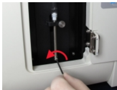
圖 12-17:以六角扳手鬆開柱塞鎖定螺絲
