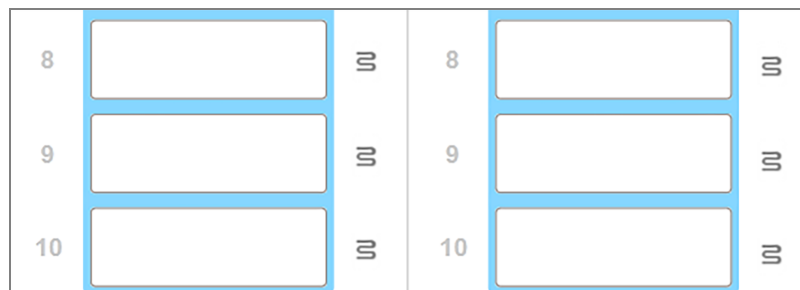
圖 5-4: 各位置的灰色加熱器符號表示完全關閉加熱
