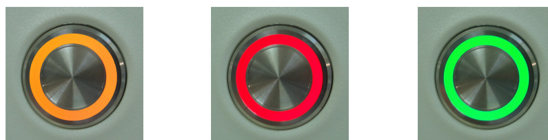
圖 2-13: 目前型號的 BOND-MAX 儀器之玻片盤 LED 色彩 (橘色、紅色、綠色)
