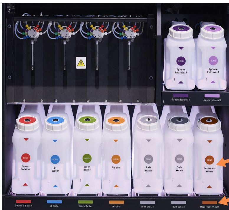
圖 2-15:位於正確位置的 BOND-III 大容量試劑容器
