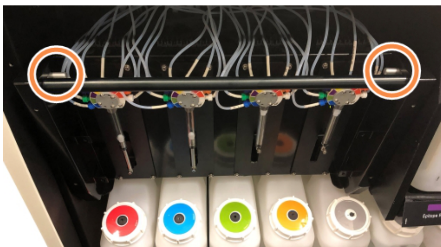
図 12-9: ユニットが開き、手が届く状態になったときのリリースピンの位置
