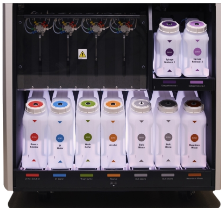
図 2-16: バルクコンテナ照明システム
