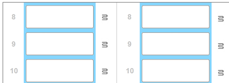
図 2-9: ヒーターの動作が停止すると、各位置のヒーターのシンボルが灰色になります。
