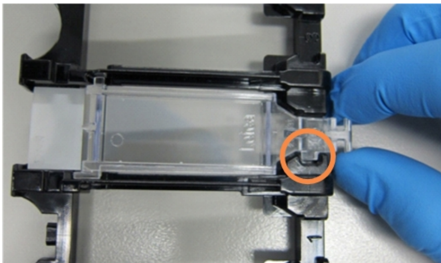
Figura 4-6: Posizionamento di una Covertile su un vetrino
