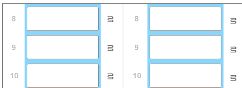
Figura 2-9: I simboli degli elementi riscaldanti in grigio in tutte le posizioni indicano una completa interruzione del riscaldamento
