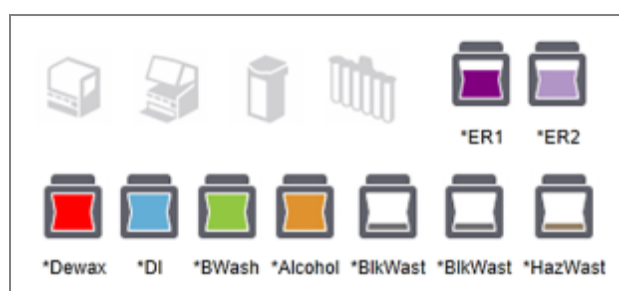
Figura 5-13: Contenitori in bulk (configurazione BOND RX)
