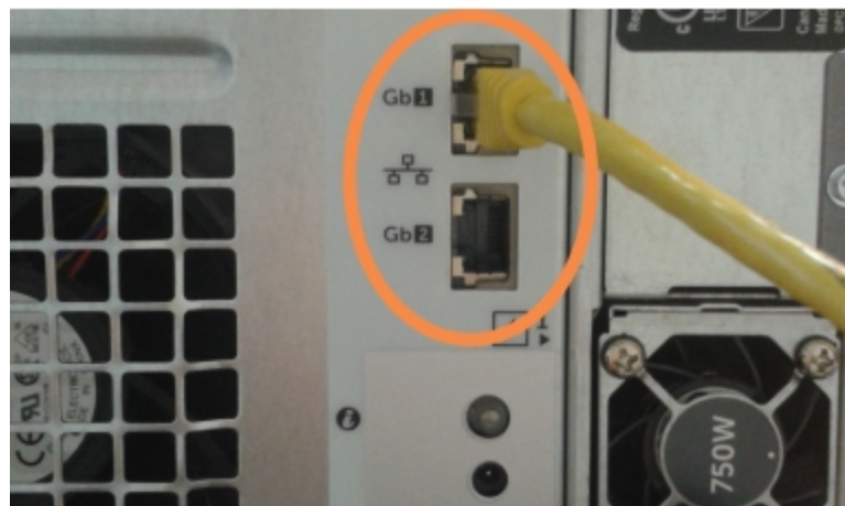
Figura 16-5: Porte Ethernet utilizzate per LIS
