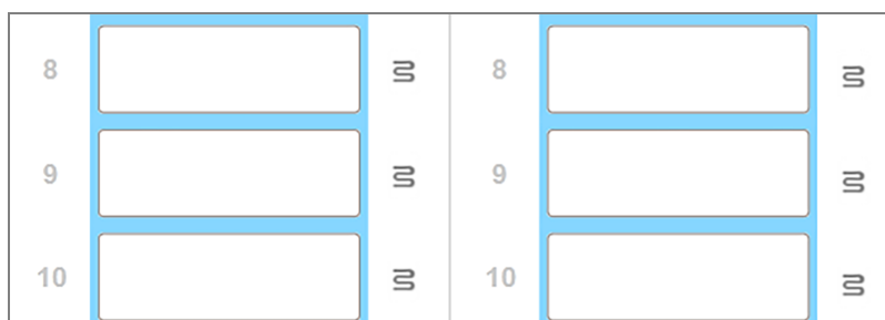
Abbildung 5-4: Wenn auf allen Positionen graue Heizelementensymbole erscheinen, wurde die Heizung komplett abgeschaltet.
