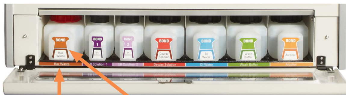
Figure 2-17: Réactifs en vrac en place dans BOND RX m
