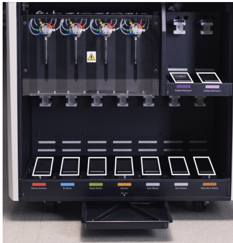
Figure 12-13: Plateaux antigoutte de contenant en vrac BOND RX montrant les capots des capteurs de poids
