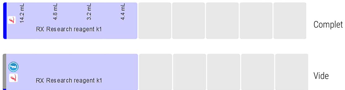
Figure 5-8: Exemples de niveaux de réactifs prêts à l'emploi indiqués sur l'écran État système
