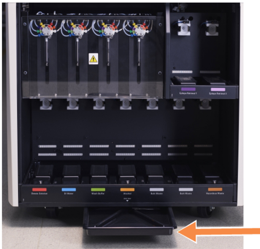
Figure 12-14: Le bac d'égouttage du module de traitement BOND RX
