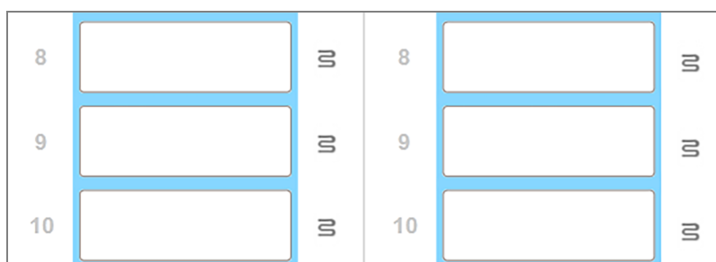
Figure 2-9: Des symboles gris de réchauffeur à chaque position signalent l'arrêt complet du réchauffeur
