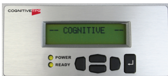
图 17-1: Cognitive 打印机的液晶显示屏和键区
