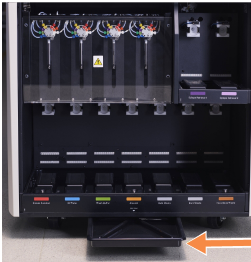
图 12-14: BOND RX 操作仪承滴盘
