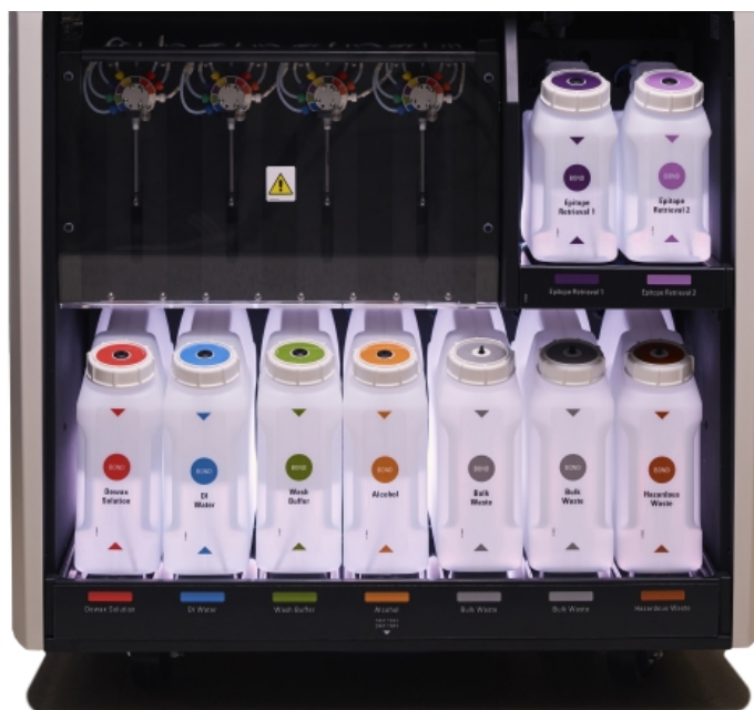
图 2-16: 大容器照明系统
