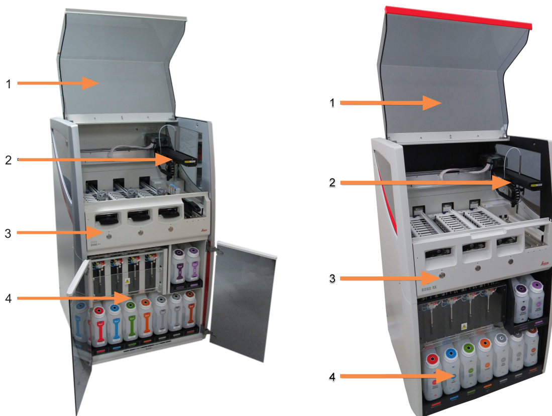
图 2-1:之前(左侧)和当前(右侧) BOND RX 操作仪的正面视图
