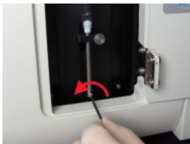
图 12-17:用内六角扳手拧开柱塞止动螺钉
