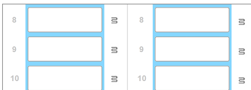
图 2-9:每个位置的灰色加热器符号表示加热被完全关闭。
