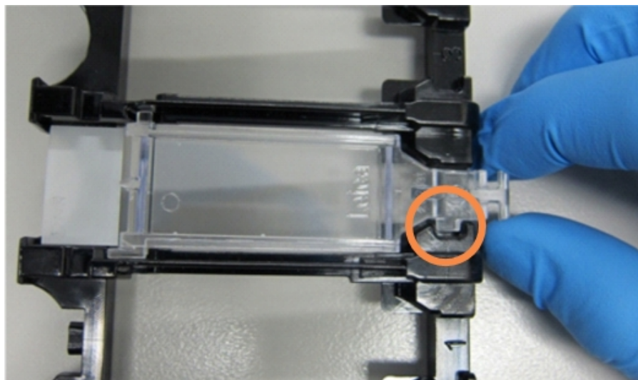
图 4-6:将 Covertile 放在玻片上
