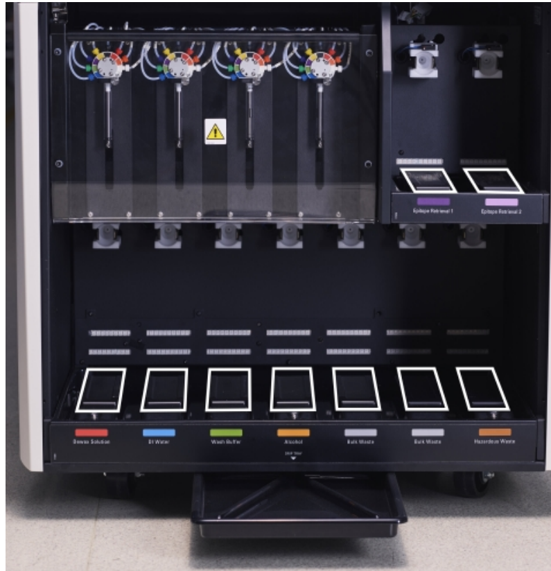
图 12-13: BOND RX 大容器承滴盘及重量传感器护盖
