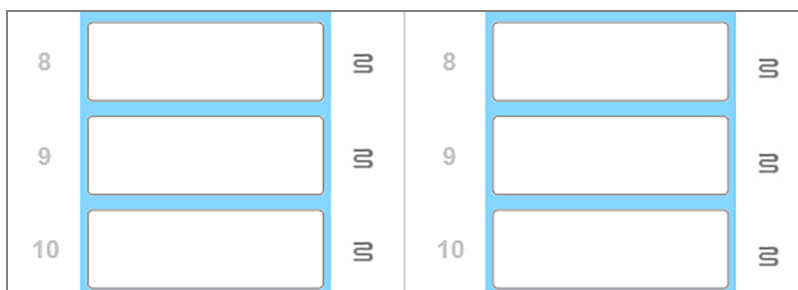
图 5-4: 每个位置的灰色加热器符号表示加热被完全关闭。
