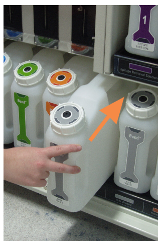
图 12-1:将废液容器放回其原先所在位置。
