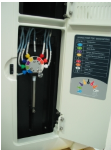
图 2-6:铰链门后面的注射器
