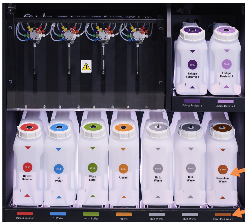
图 2-15: BOND RX 大容量试剂容器已就位
