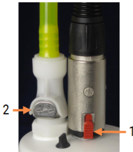
图 12-4:外部废液容器连接
