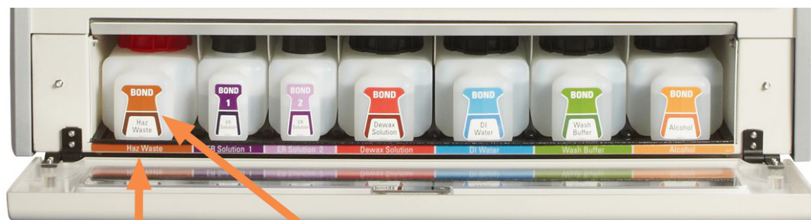
图 2-17: BOND RX m 大容量试剂的摆放位置
