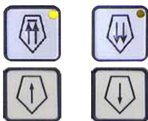
双速电动粗进用于快速将样品移向和移离切片刀。使用双箭头按钮时，粗进以 900 μm/s 的速度运行；使用单箭头按钮时，则以 300 μm/s 的速度运行。
