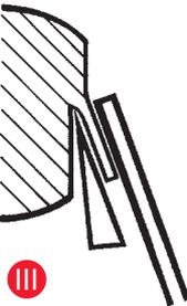
**图 III:** 防卷板相对于切片刀的正确位置
