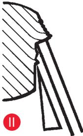
**图 II:** 切片后切片撕裂且样品块碰撞玻璃插件。
