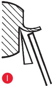
**图 I:** 切片在防卷板系统的玻璃插件上卷起。
