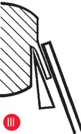
**Рис. III:** Правильное положение уголка относительно режущей кромки
