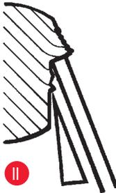
**Рис. II:** Срез разрывается, и блок после срезания наталкивается на стеклянную вставку.
