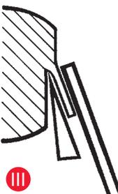
**Fig. III:** correggere la posizione della guida stendifetta rispetto al tagliente
