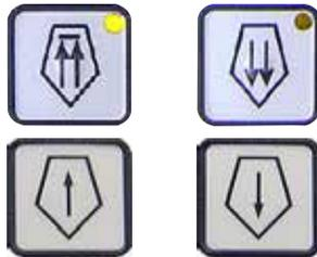
Il movimento macrometrico a due velocità è preposto ad una rapida traslazione del preparato in avvicinamento alla lama e in allontanamento dalla lama. Con i pulsanti a doppia freccia, l'avanzamento macrometrico è pari a 900 µm/s; con i pulsanti a freccia singola a 300 µm/s;
