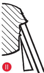
**Fig. II:** la sezione si strappa e il blocco urta sull'inserto di vetro dopo il sezionamento.
