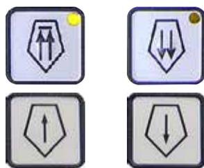
El avance macro de dos velocidades sirve para el desplazamiento rápido de la muestra hacia la cuchilla así como en dirección opuesta. Al pulsar las teclas de flecha doble, la velocidad de desplazamiento es de 900  $\mu\text{m/s}$ ; con las teclas de flecha simple, es de 300  $\mu\text{m/s}$ .
