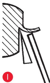
**Fig. I:** el corte se enrolla por encima de la inserción de cristal del sistema antirroll.
