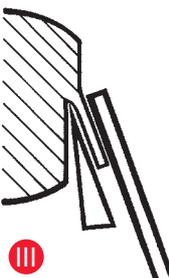
**Figura III:** placa antirroll en la posición correcta para practicar un corte
