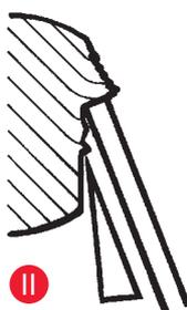
**Fig. II:** el corte se rompe y colisiona con la inserción de cristal después de haberlo cortado.
