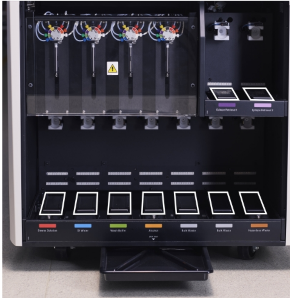
Attēls 12–13: BOND-III lielapjoma konteineru notekaplātes, kurās redzami svāra sensoru apvalki
