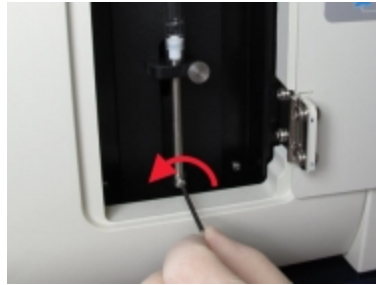
Attēls 12–17: Virzuļa fiksēšanas skrūves atskrūvēšana ar sešstūra atslēgu
