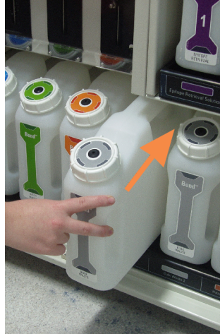
Рис. 12-1: Возвращение контейнера для отходов на прежнее место
