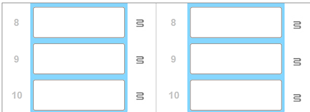
Рис. 2-8: Серые значки нагревателей во всех положениях указывают на полное отключение нагрева
