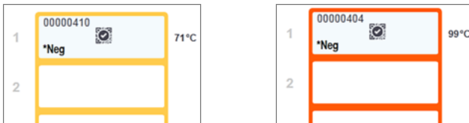
Рис. 5-6: Индикация температуры на границах лотков для препаратов: теплый (слева) и горячий (справа)
