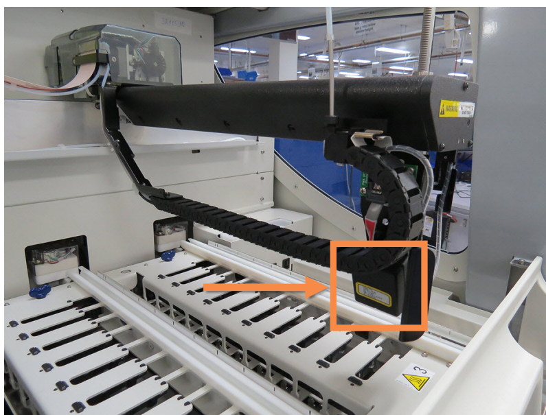
Рис. 2-б: Фотография основного робота с показанным стрелкой считывателем идентификаторов
