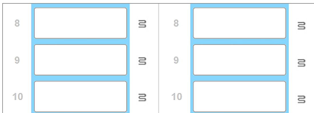
Рис. 5-4: Серые значки нагревателей во всех положениях указывают на полное отключение нагрева
