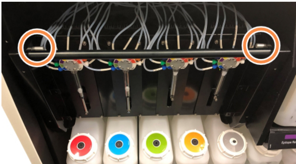
Рис. 12-9: Расположение штырьков разблокировки в открытом для доступа модуле
