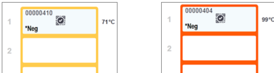
圖 5-6:玻片盤的溫度指標背景：溫 (左) 和 熱 (右)
