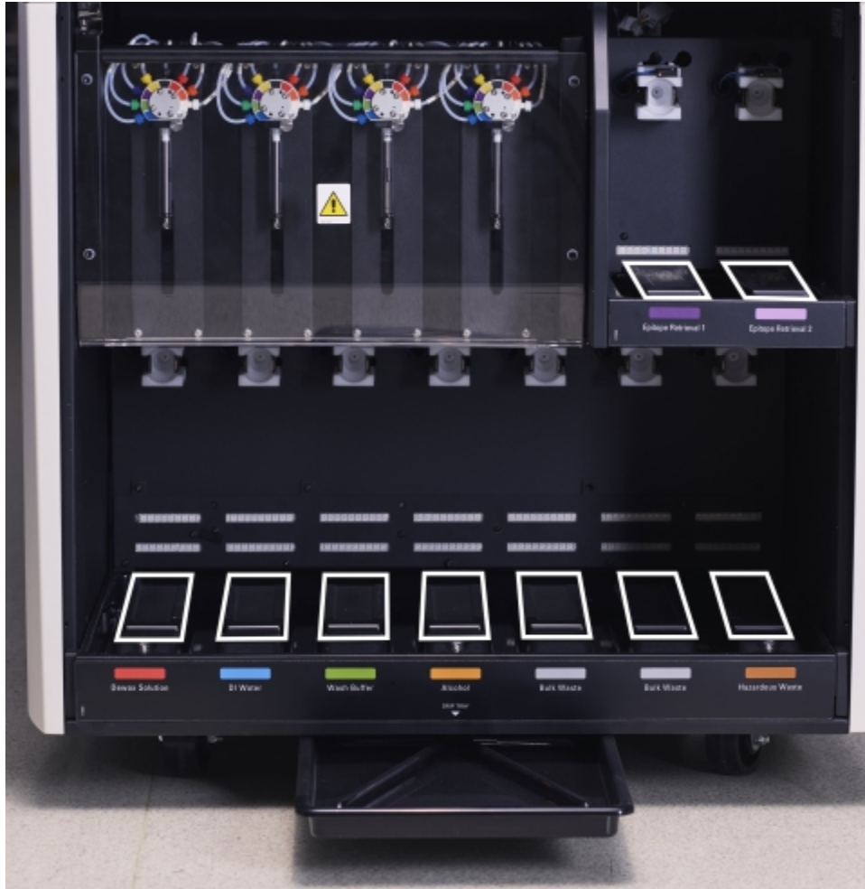
圖 12-13: BOND-III 大容器滴水盤顯示重量感應器蓋子
