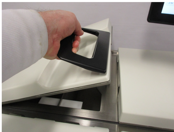
Сурет 2-13: Парафинді ванна қақпағын ашу
