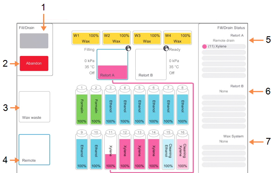
Сурет 5-9: Аппараттық толтыру/дренаж (Remote fill/drain) экраны
