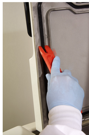
Сурет 7-3: Парафин қырғышын пайдалану
