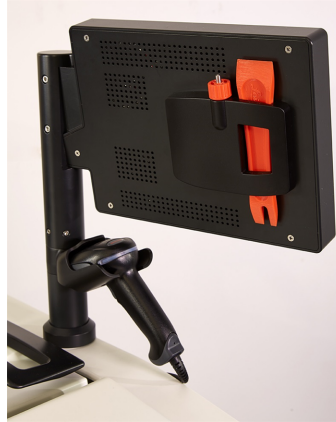
Εικόνα 7-1: Θέση των εργαλείων καθαρισμού
