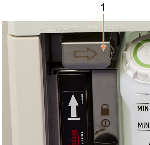
Εικόνα 5-11: Ανοιχτό επικάλυμμα απομακρυσμένης πλήρωσης/αποστράγγισης με τη γραμμή αντιδραστηρίων (αριστερά) και τη γραμμή αποβλήτων παραφίνης (δεξιά).
