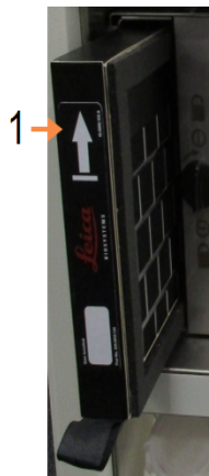
Abbildung 7-12: Einsetzen des Aktivkohlefilters mit dem Richtungspfeil (1) nach oben
