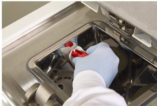
Abbildung 7-4: Verwenden des Reinigungswerkzeugs für Füllstandssensoren
