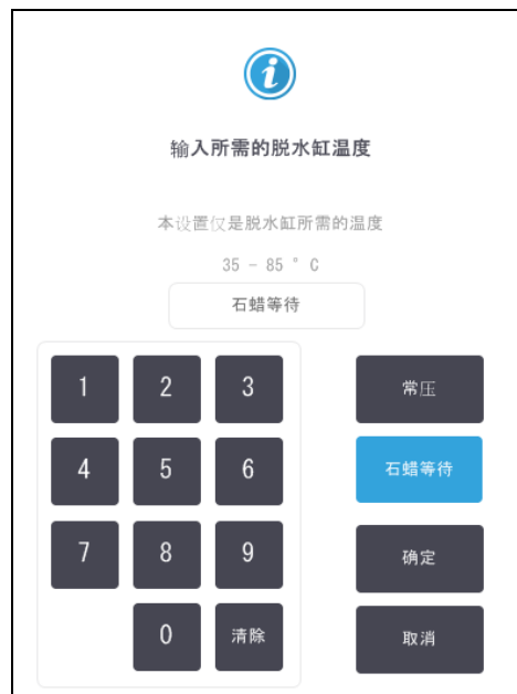
图 6-2:将脱水缸温度设置为石蜡等待温度
