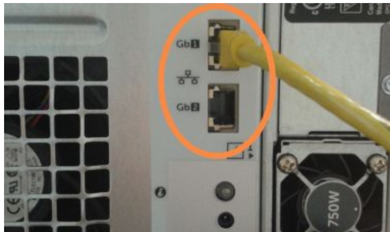
Малюнок 16-5: Порти Ethernet, що використовуються для підключення до ЛІС
