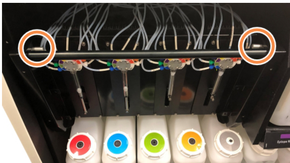
Rysunek 12-9: Położenie kołków zwalniających przy otwartej jednostce
