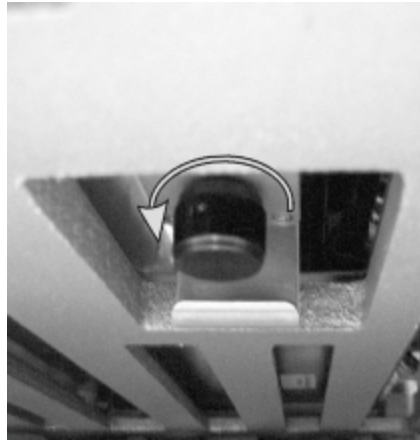
Rysunek 12-10: Ręczne pokrętko zwalniasjące
