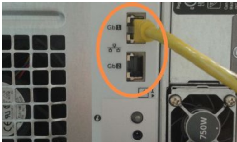
Rysunek 16-5: Porty Ethernet używane do łączności z LIS
