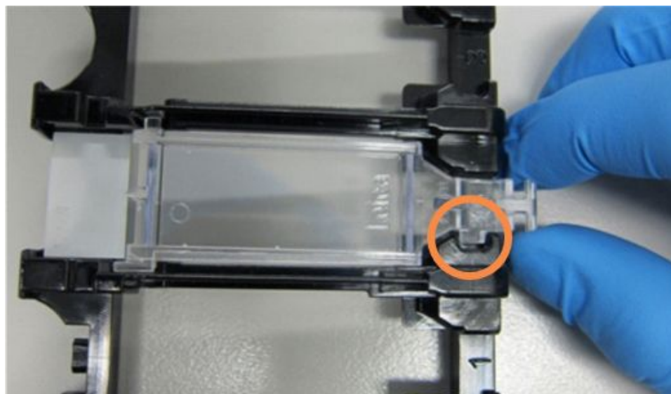
Rysunek 4-6: Ustawianie szkiełek nakrywkowych Covertile na szkiełku
