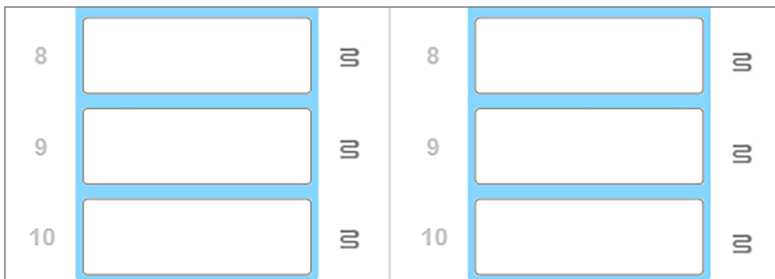
Rysunek 5-4: Szare symbole podgrzewaczy we wszystkich pozycjach oznaczają całkowite wyłączenie podgrzewania
