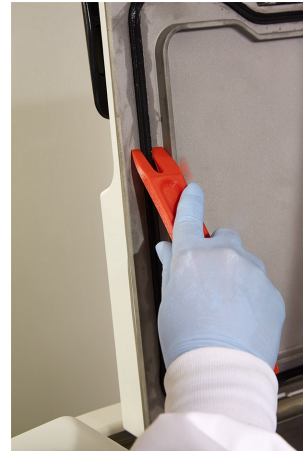
Şekil 7-3: Parafin kazıyıcının kullanılması
