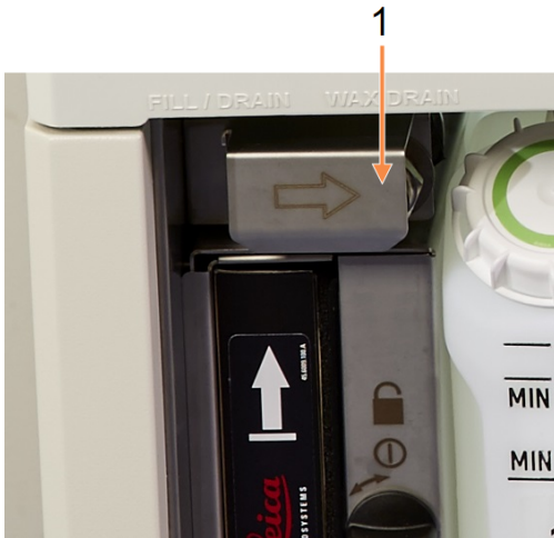
Şekil 5-11: Uzaktan dolum/tahliye kanadı, reaktif hattı (sol) ve atık parafin hattı (sağ) ile açılır.
