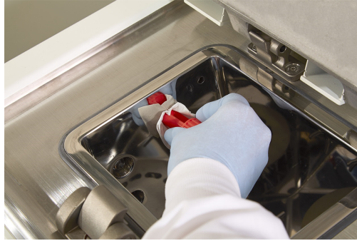
Şekil 7-4: LLS temizleme aracının kullanılması
