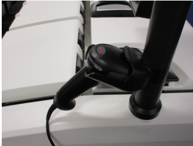
Şekil 2-15: Tutucunun içerisindeki barkod tarayıcısı
