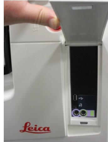
Şekil 2-19: Kanadın arkasındaki ön USB bağlantı noktası
