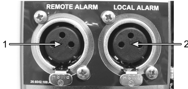
Şekil 2-23: Uzak alarm (1) ve yerel alarm (2) konektörleri
