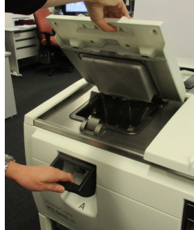
Figur 2-3: Öppna ett kammarlock
